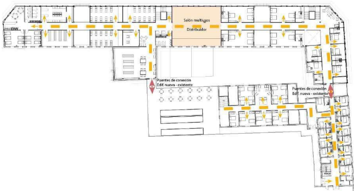
FIGURA 4.16: Pasillo central. Fuente: Elaboración propia
