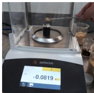
Figura 18: Balanza analítica para el pesaje de la muestra
