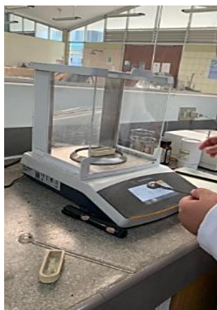
Figura 22: Pesaje de la muestra para el análisis de Azufre
