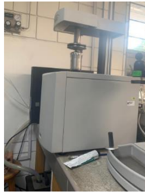
Figura 7: Bomba calorimétrica de Emerson para la medición de poder calórico
