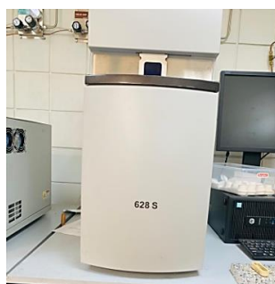
Figura 24: Puerta del horno para el análisis de azufre
