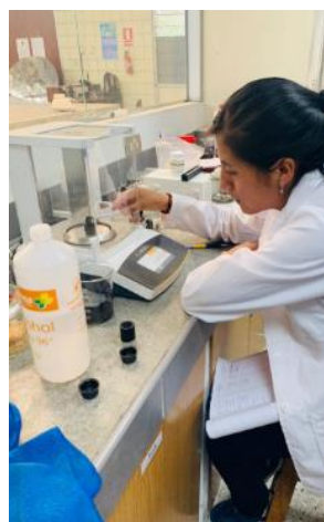
Figura 25: Peso de la muestra para el análisis de poder calórico
