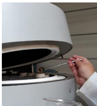
Figura 30: Colocación de las muestras de biomasa en el horno
