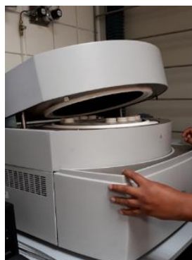
Figura 31: Horno termogravimétrico para el análisis de humedad y producción de biochar
