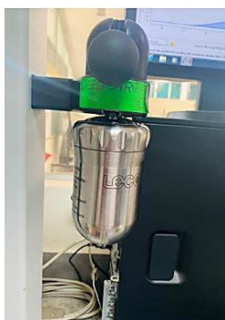
Figura 27: Bomba calorimétrica para análisis de poder calórico
