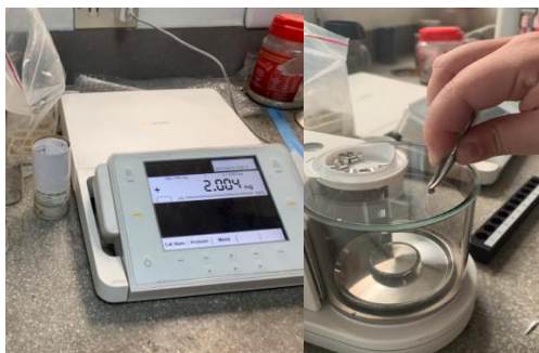
Figura 20: Micro balanza para pesar la muestra de biomasa o biochar
