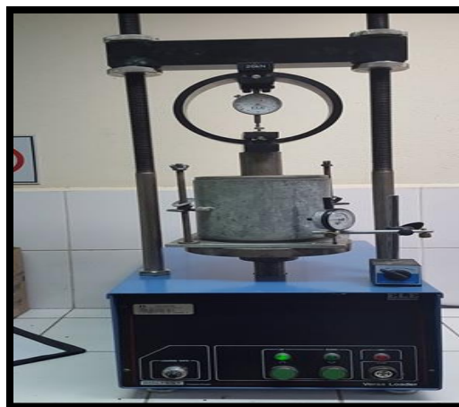
Figura 24: Ensayo de la capacidad soportante del suelo.
