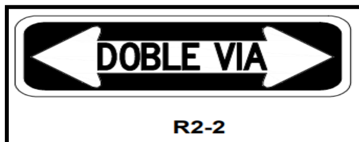
Figura 42: Señalización vertical: doble vía.
