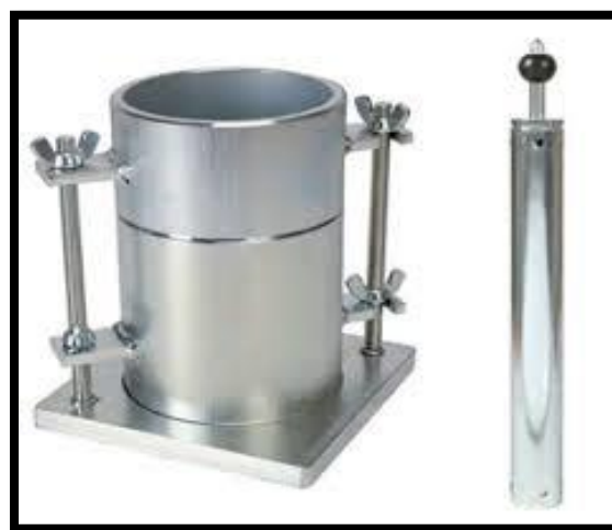
Figura 28: Equipos que se utilizaron para realizar el ensayo de densidad máxima seca. Fuente: Elaboración propia
