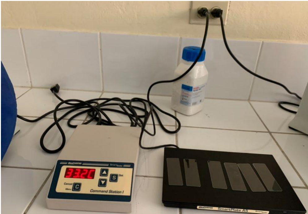
Foto N° 15. Secado de muestras en la placa térmica.
