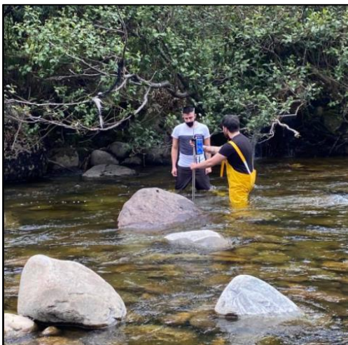
Figura 4. Medición de caudales con el molinete
