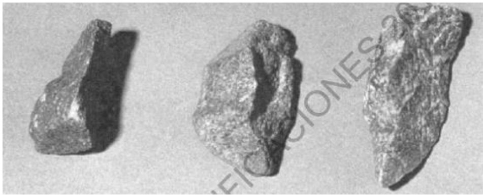
Ilustración 18. Partículas fracturadas: bordes agudos, superficies rugosas. Fuente: (Instituto Nacional de Vías de Colombia, 2013)
