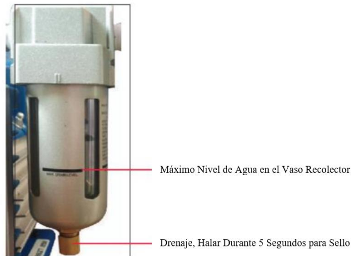
Ilustración 9. Drenaje para sello y máximo nivel de agua del vaso recolector en el equipo de ensayos RICE. Fuente: Pinzuar (2002)
