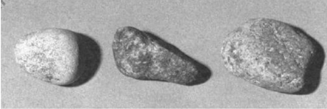
Ilustración 23. Partículas no fracturadas: partículas redondeadas, superficies lisas. Fuente: (Instituto Nacional de Vías de Colombia, 2013)
