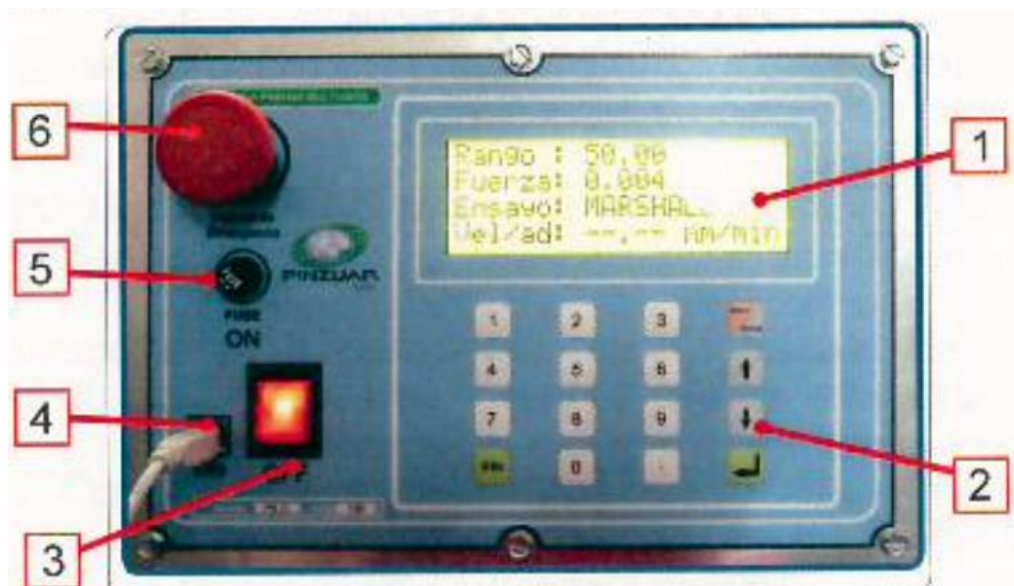
Ilustración 7. Tablero de indicación y control del equipo multiusos automático para ensayos CBR-Marshall. Fuente: Pinzuar LTDA (2002)
