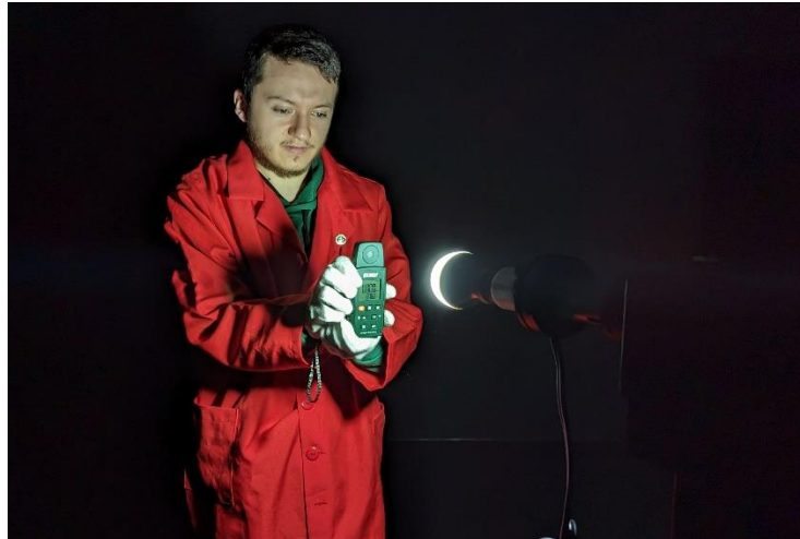
Fig. 46 Medición de irradiancia con el equipo Extech UV510
