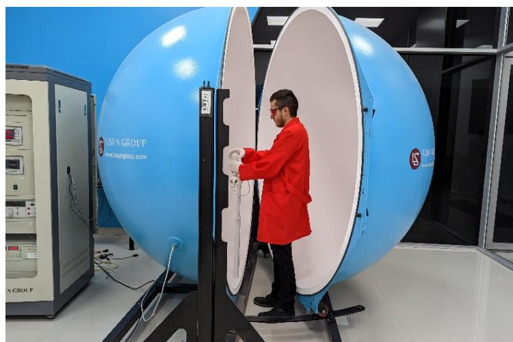
Fig. 39 Colocación de la lámpara dentro de la esfera.
