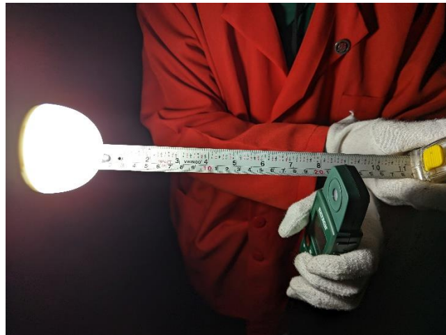
Fig. 45 Distancia para la medición de irradiancia según la norma IEC 62471.
