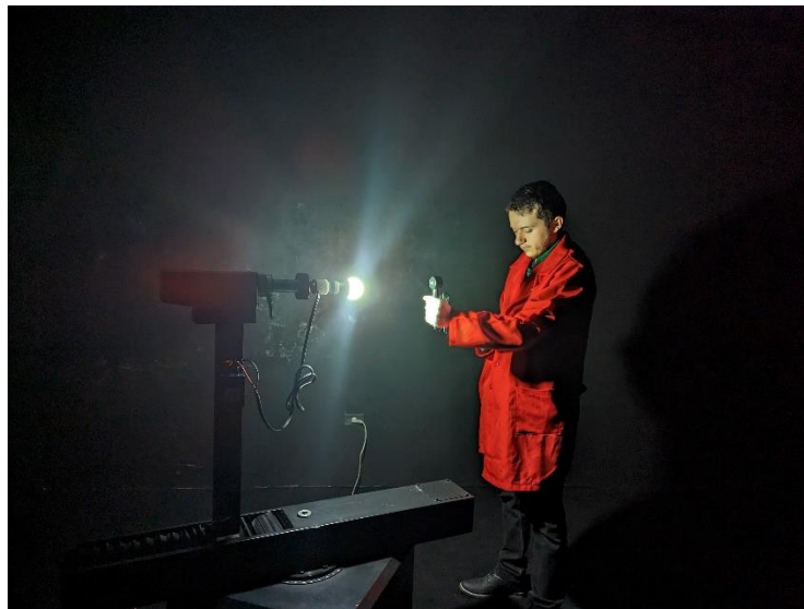
Fig. 47 Medición de irradiancia con el equipo Extech SDL470
