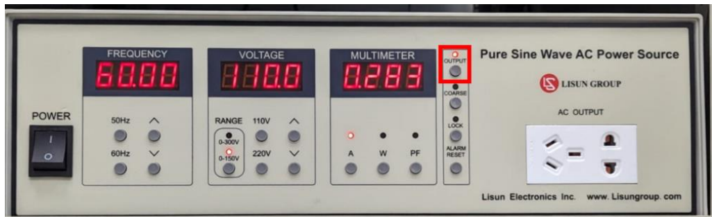
Fig. 43 Manera correcta de cortar energía desde la fuente.
