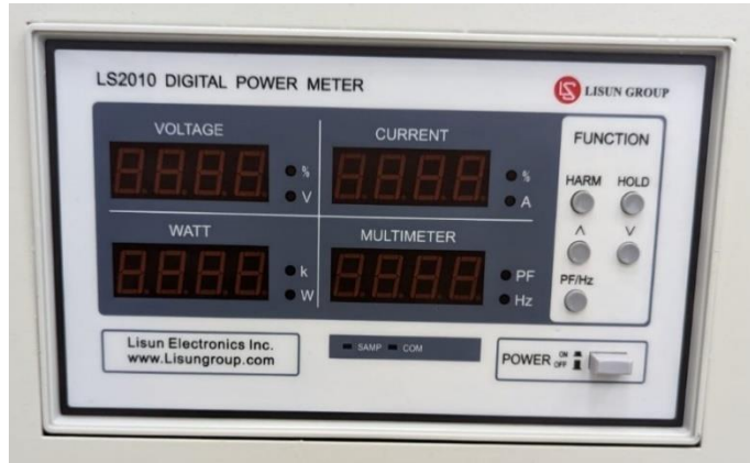
Fig. 33 Medidor de energía digital LS2010
