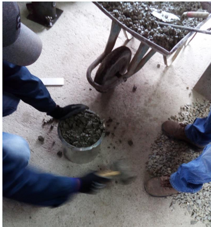
Figura 16. Ensayo de peso específico de la mezcla.
