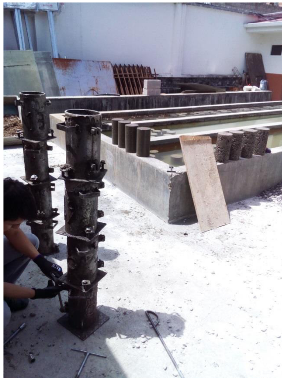
Figura 20. Desencofrado de las probetas.
