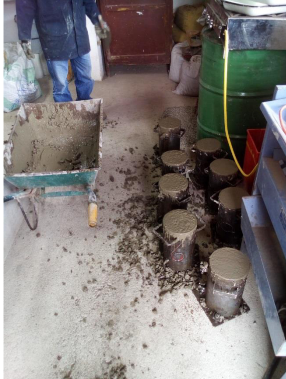
Figura 19. Probetas fraguando antes de desencofrar.
