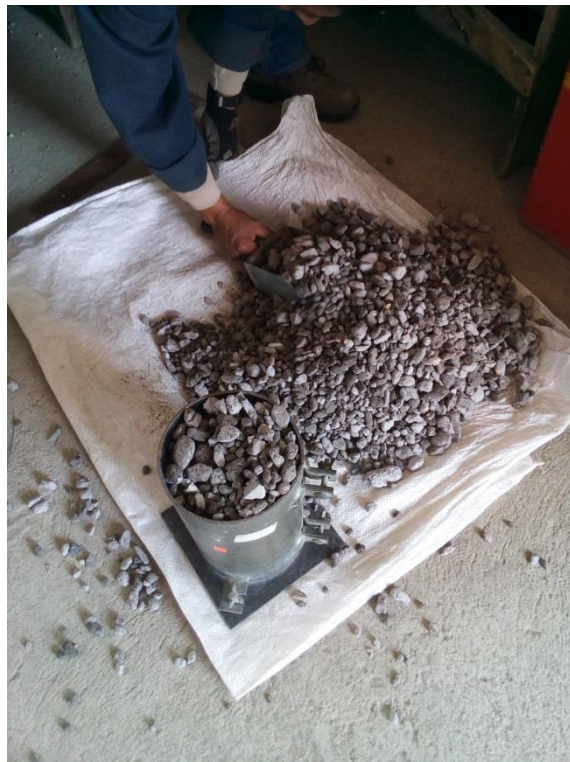
Figura 10. Ensayo de peso volumétrico.
