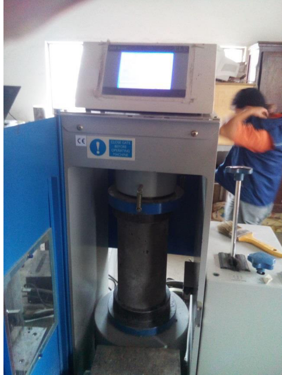
Figura 29. Probeta en la prensa hidráulica en el momento del ensayo de carga.
