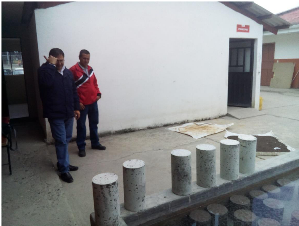
Figura 24. Secado de probetas antes de realizar los pesos, mediciones y ensayo de carga.
