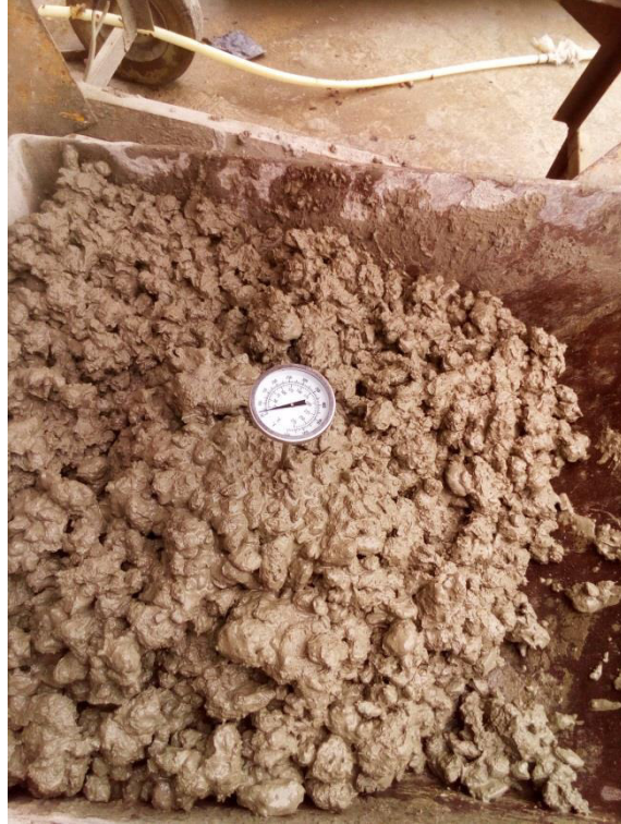
Figura 15. Ensayo de temperatura de la mezcla.
