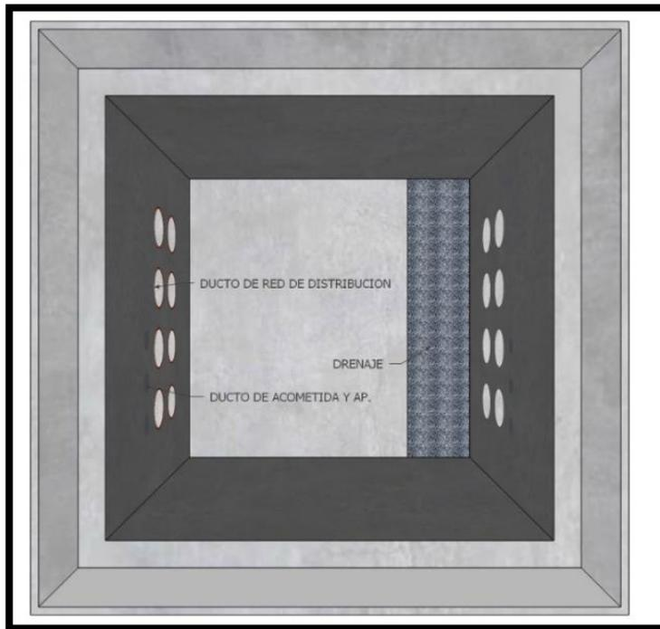
Fig. 35 Drenaje del pozo
