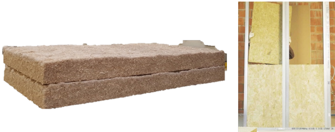
FIGURA 3.2: Panel de fibra de arroz y estructura aislante de pared a base de paneles de paja de arroz. Producto ecológico utilizado para el aislamiento térmico y acústico de las paredes. Adaptado a las exigencias de sismo resistencia de la NEC por ser un material liviano. Adaptado de Construcción con biomateriales, RT Actualidad (2017)
