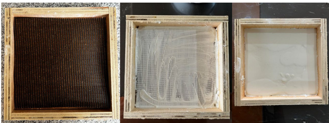
16) Malla polietileno entre hilada a cada 3 mm
