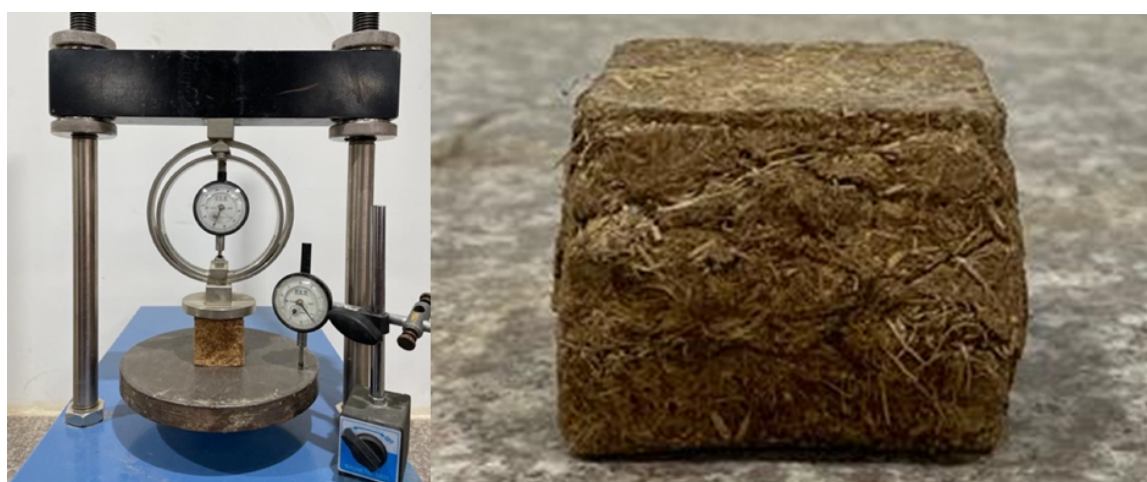
FIGURA 4.10: Ensayo de compresión probeta de Totora triturada (P3).
