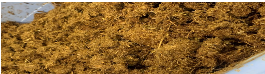
11) Mezcla de totora triturada en conjunto de aglomerante
