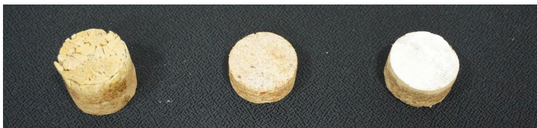
28) M1 Totora entera + Totora triturada; M2 Totora triturada; M3 Totora triturada + Cemento blanco.
