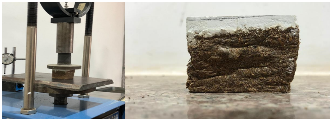
FIGURA 4.11: Ensayo de compresión probeta de Totora triturada + tallo de Totora (P2).
