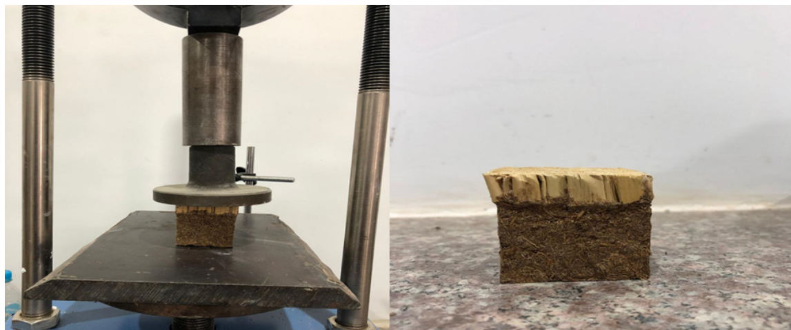
FIGURA 4.12: Ensayo de compresión probeta de Totora triturada + cemento blanco (P3).
