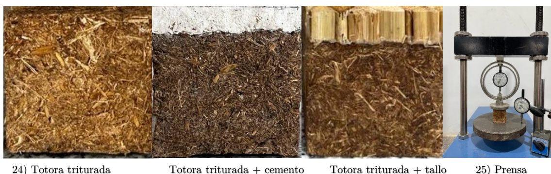
FIGURA 4.9: Ensayo de compresión probetas y equipo utilizado.
