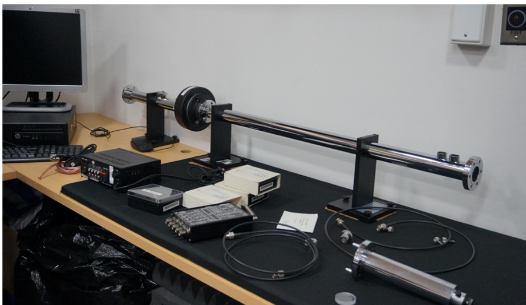
FIGURA 4.20: Tubo de impedancia Spectronics prueba coeficiente de absorción
