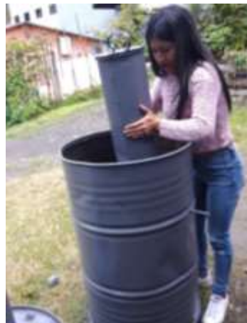
Anexo 14. Colocación del reactor en el horno de pirólisis
