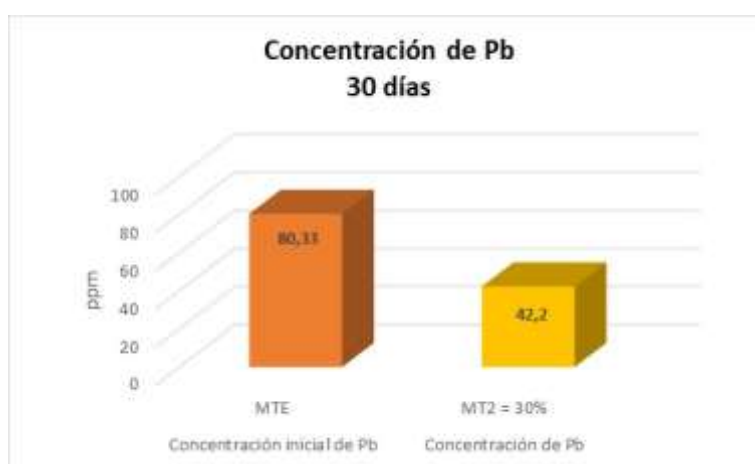
Figura 12. Concentración de plomo a los 30 días de la aplicación de biochar al 30 %
