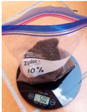
Anexo 34. Tratamiento 1: 500 g de suelo con biochar en funda Ziploc
