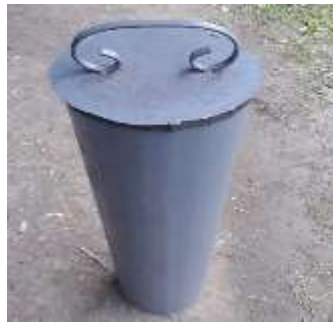
Anexo 10. Reactor de pirólisis
