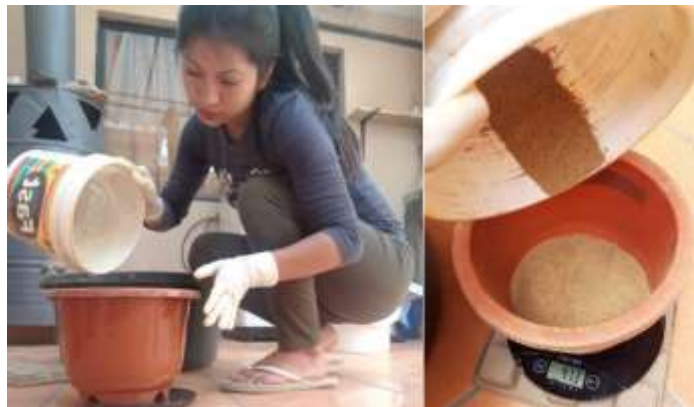
Anexo 19. Pesaje del suelo a partir de una maceta y una balanza digital.
