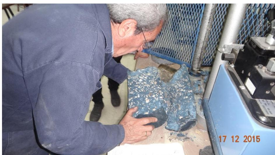
Fuente: Vallejo E. (2015). Rotura de probeta de concreto. [Foto]. Cuenca, Ecuador. Archivo del autor
