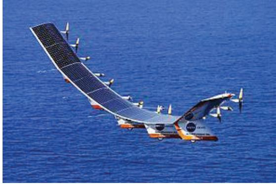
Fig. 17: Imagen del prototipo Helios, avión no tripulado de la NASA propulsado mediante energía solar fotovoltaica.
