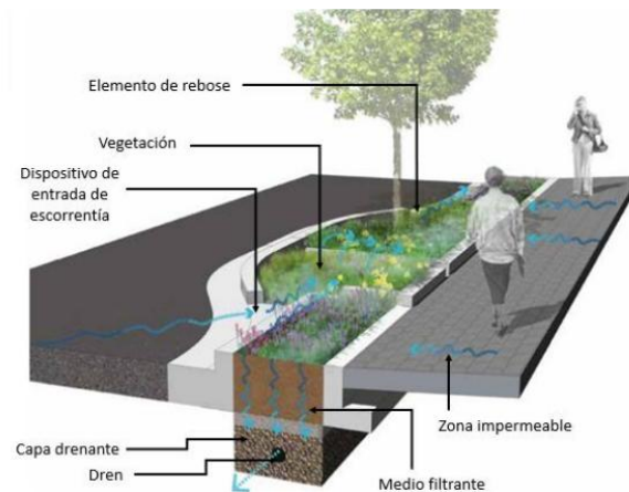
Figura 8: Esquema de un parterre inundable
