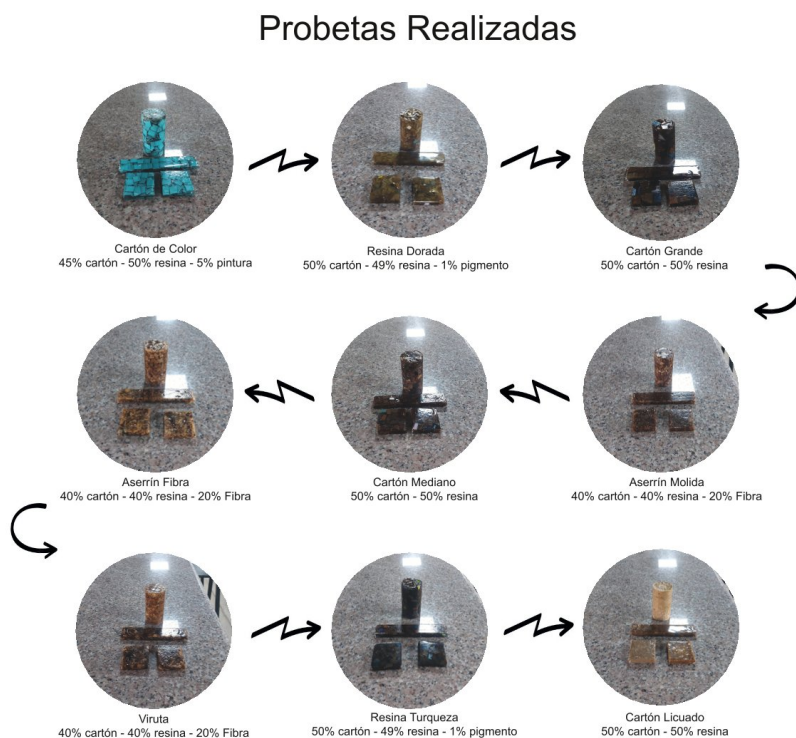
FIGURA 2.4: Foto de probetas realizadas.
