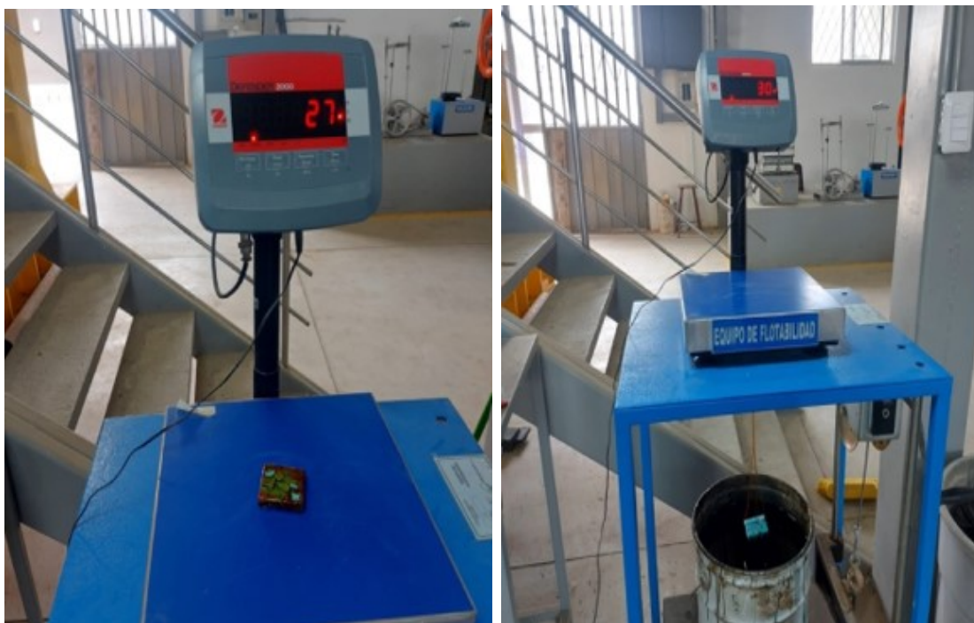
FIGURA 2.19: Proceso para la prueba de densidad. Fuente: elaboración propia.
