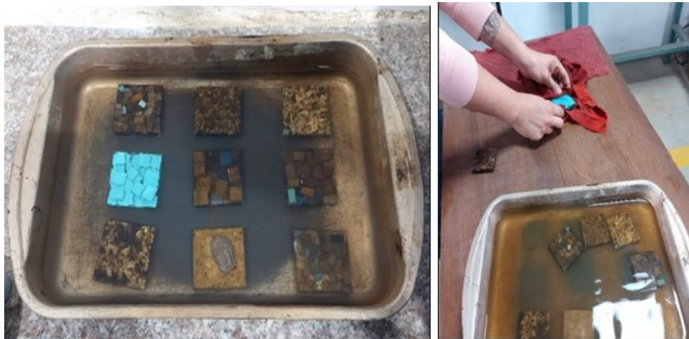
FIGURA 2.17: Procesos para la prueba de absorción de agua. Fuente: elaboración propia
