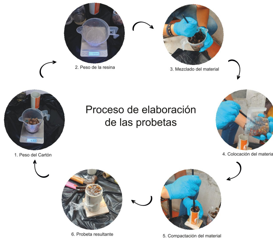
FIGURA 2.3: Proceso de elaboración de las probetas.
