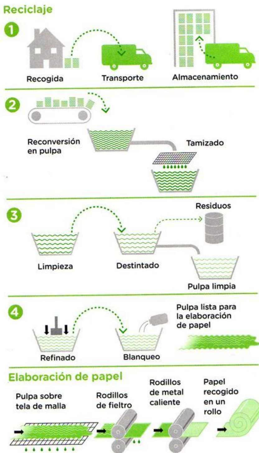
FIGURA 1.31: Diagrama general del proceso de reciclado de cartón. Tomado de: Proceso de reciclaje del papel y del cartón, IQR, 2020.
