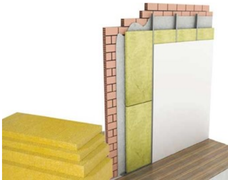
FIGURA 1.10: Aislante térmico y acústico de pared. Tomado de: Soluciones especiales para la construcción, Soluciones especiales, 2022.
