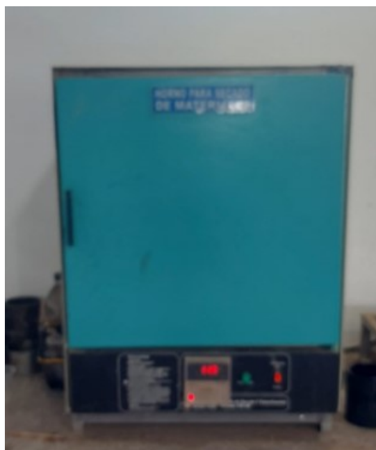
FIGURA 2.18: Foto del horno industrial. Fuente: elaboración propia. Nota: horno utilizado para la prueba de absorción de agua.
