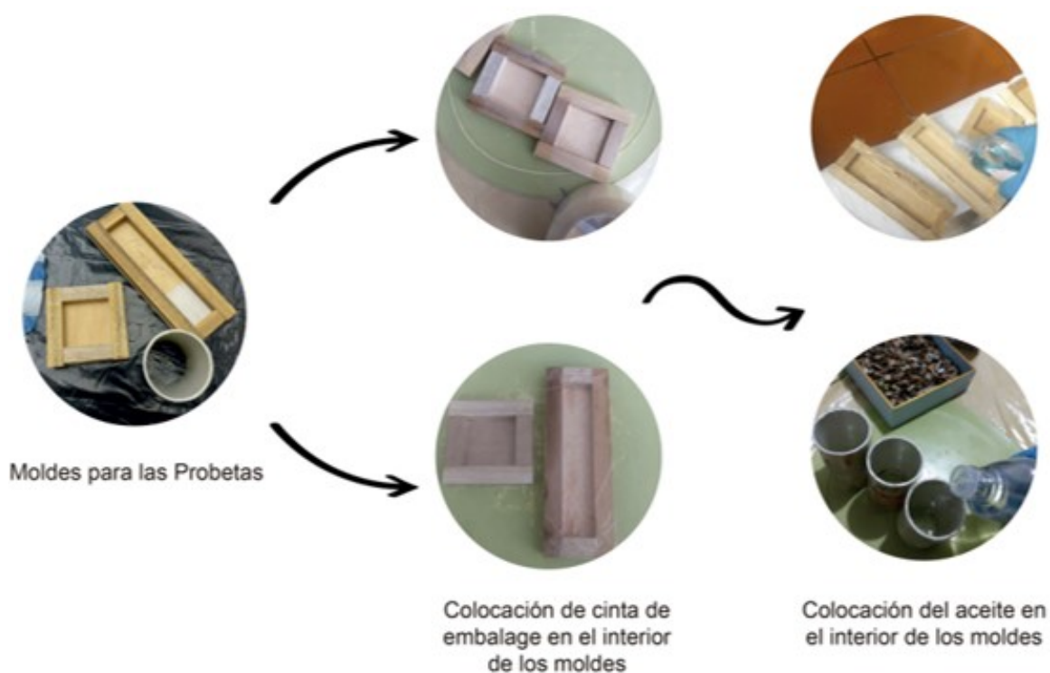
FIGURA 2.2: Proceso de elaboración de los moldes.
