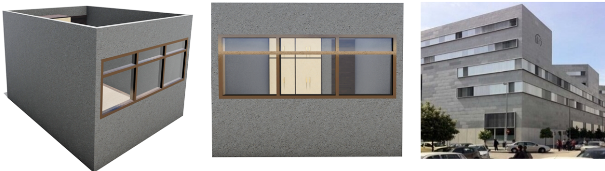
FIG. 4.15: Ventana longitudinal, WWR 40%. De izquierda a derecha: perspectiva, alzado y modelo de aplicación.
