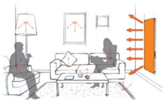
FIG. 1.15: Temperatura radiante de objetos
