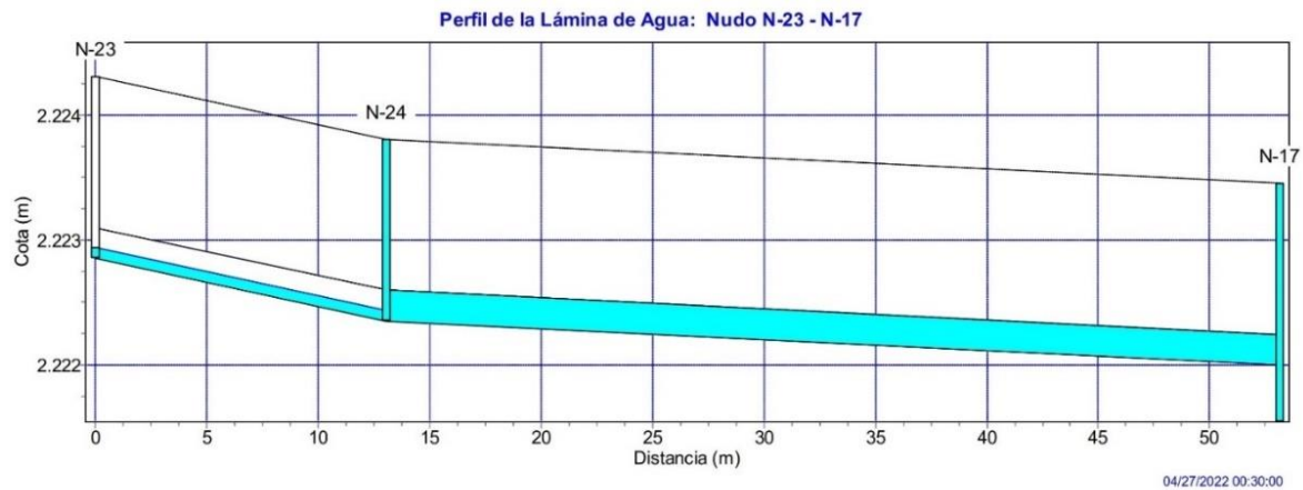
Figura 28 Perfil de la Lámina de Agua del Nudo N-23 al N-17
