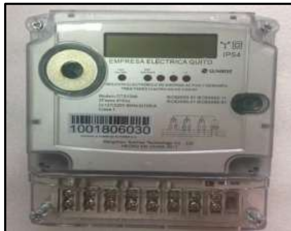
Figura 2 a) medidor bifásico con RF, b) medidor trifásico con RF
