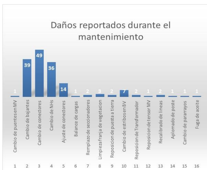
Figura 24. Daños comunes en el mantenimiento de transformadores Alim. 0325.
