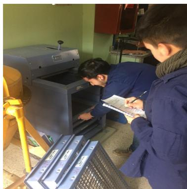
Figura 7.5: Tamizadora utilizada para análisis granulométrico de partículas gruesas.
