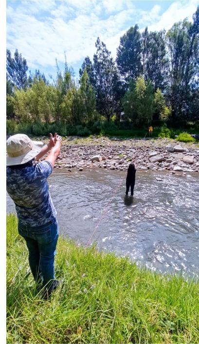
(b) Línea de referencia en sección de aforo
