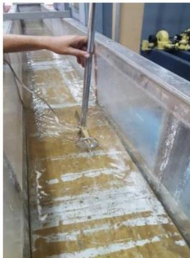
Figura 2.9: Molinete utilizado para aforos en laboratorio [35].
