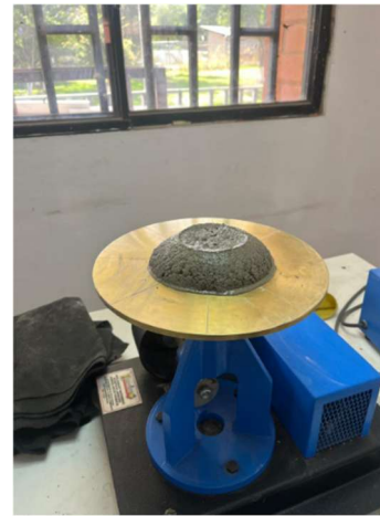
Diámetro incrementado mortero cemento-arena
