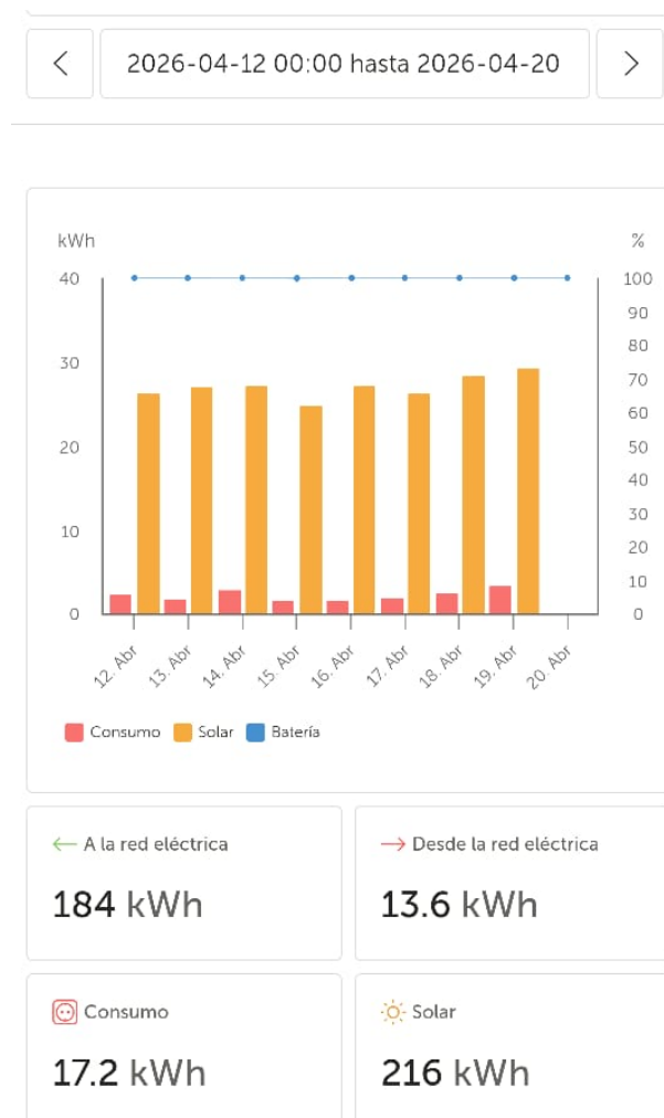
Figura 21. diagrama de barras comparativo Consumo Vs Solar en fase de prueba de inyección a la red Fuente: plataforma de monitoreo del sistema Victron Energy (VRM)
