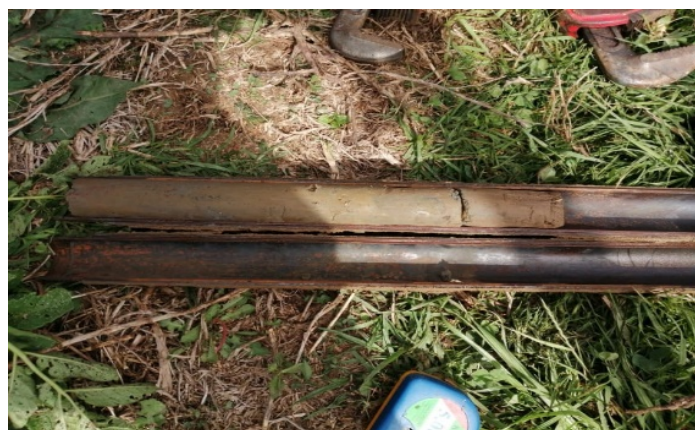
Figura 13: Muestras inalteradas, ensayo SPT Fuente: Los Autores.
