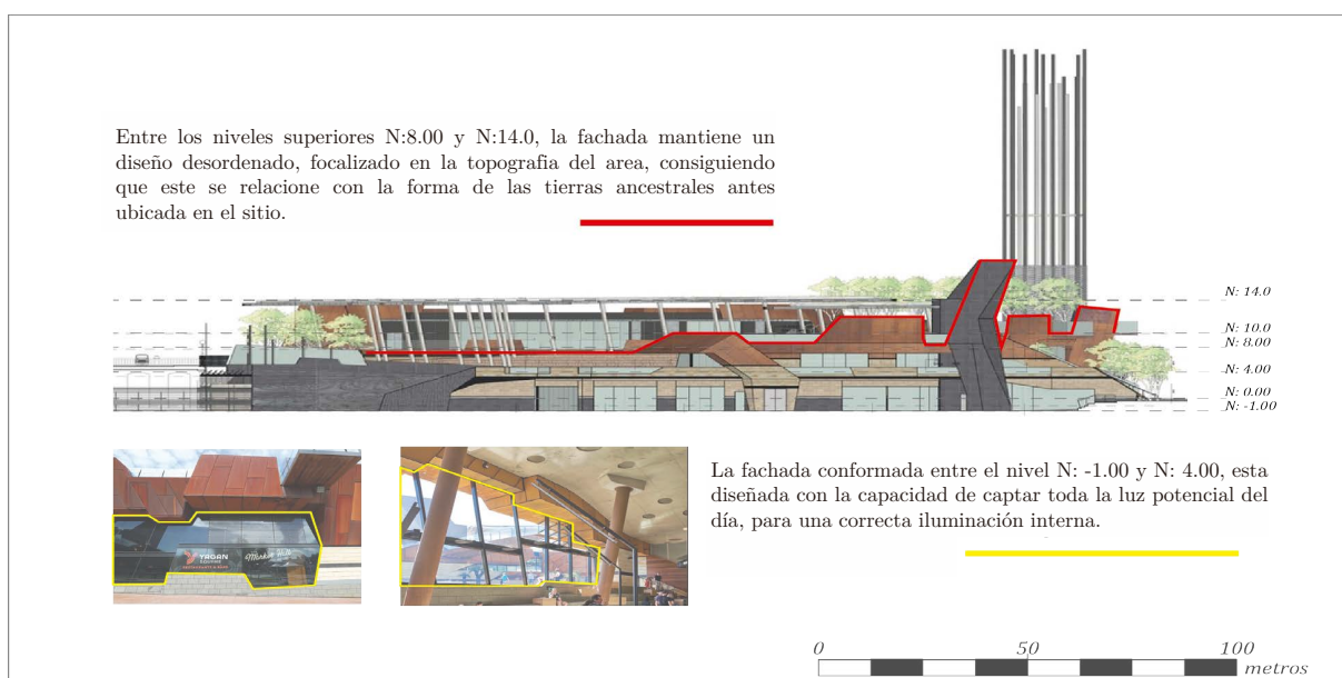
FIGURA 2.28: Elevación longitudinal. Fuente:Lyons (2014). Elaboración: Propia.
