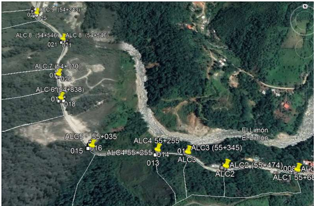
Gráfico N° 1: Alcantarillas, cunetas y microcuencas (1-9)
