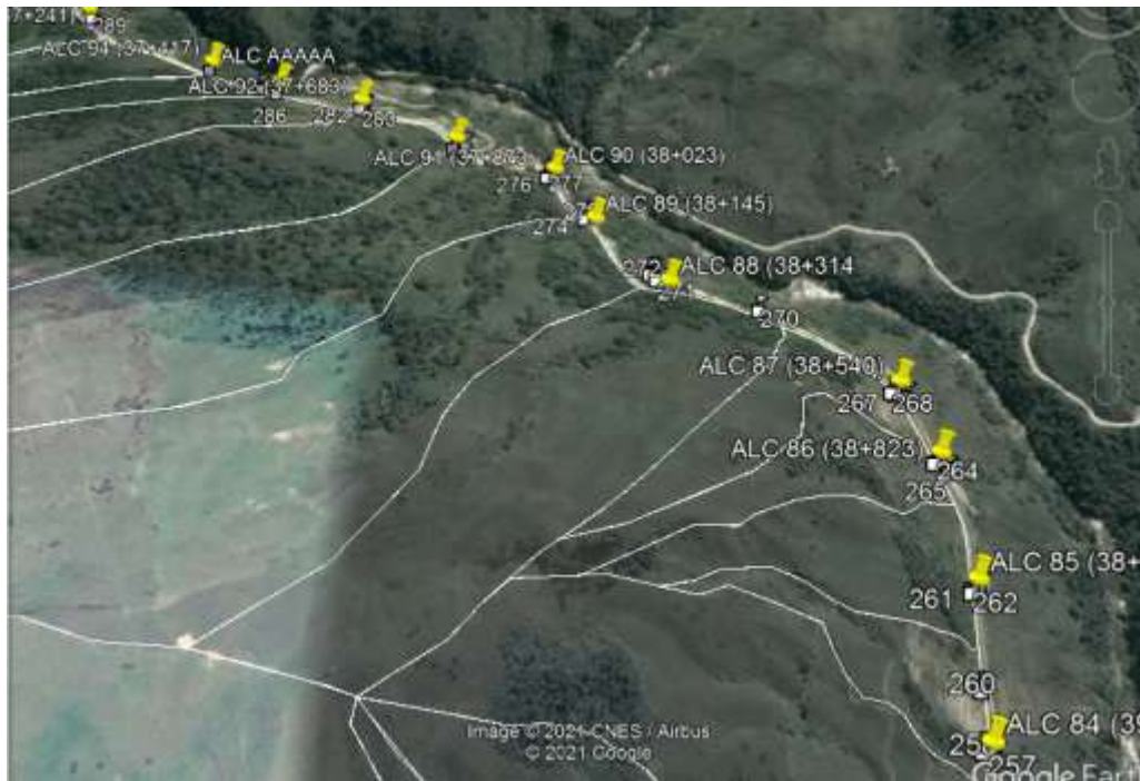
Gráfico N° 11: Alcantarillas, cunetas y microcuencas (84-94)
