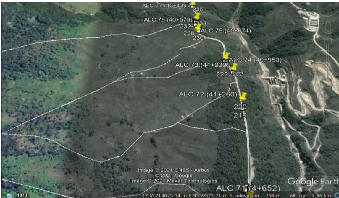
Gráfico N° 9: Alcantarillas, cunetas y microcuencas (70-77)
