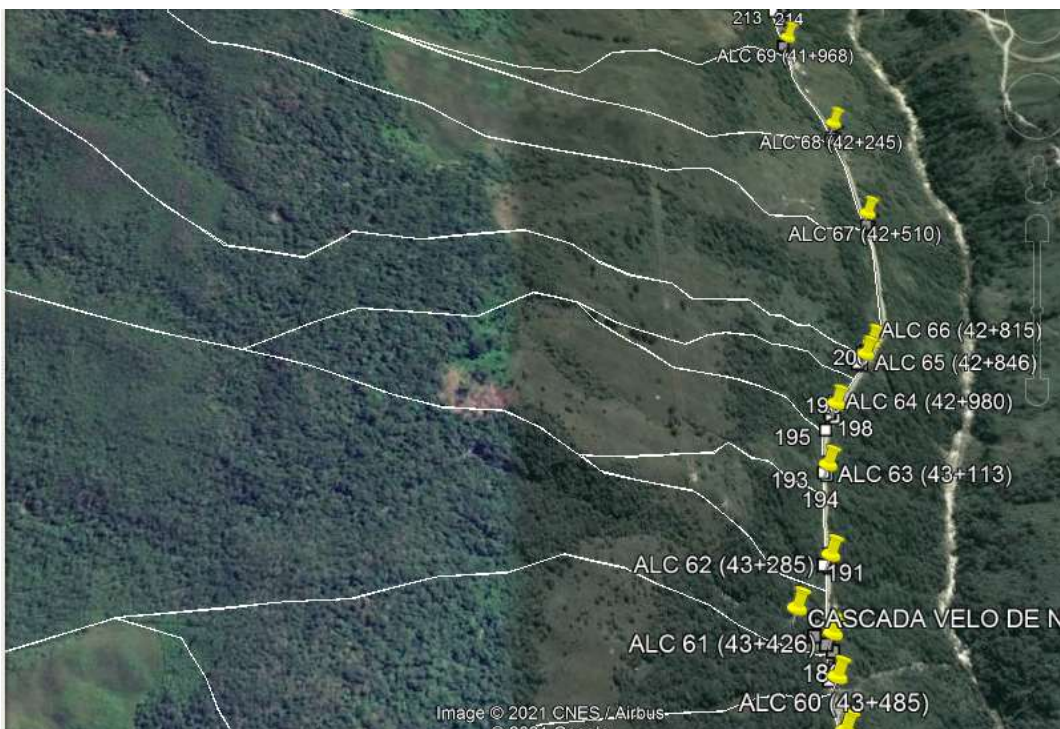
Gráfico N° 8: Alcantarillas, cunetas y microcuencas (60-69)
