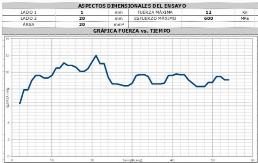
FIGURA 4.26: Resultado – probeta 3 Fuente: INEN 109 Elaboración: Propia
