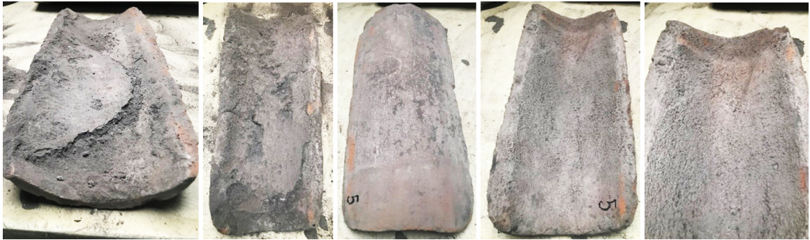
FIGURA 4.18: Muestras de tejas que estuvieron expuestas a ceniza volcánica hasta la actualidad – Bilbao
