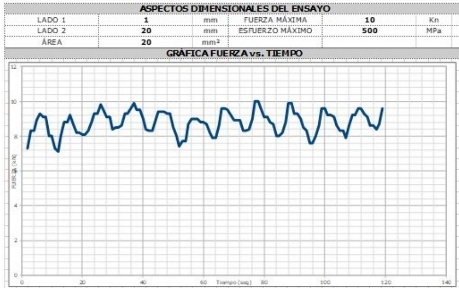
FIGURA 4.24: Resultado – probeta 1 Fuente: INEN 109 Elaboración: Propia
