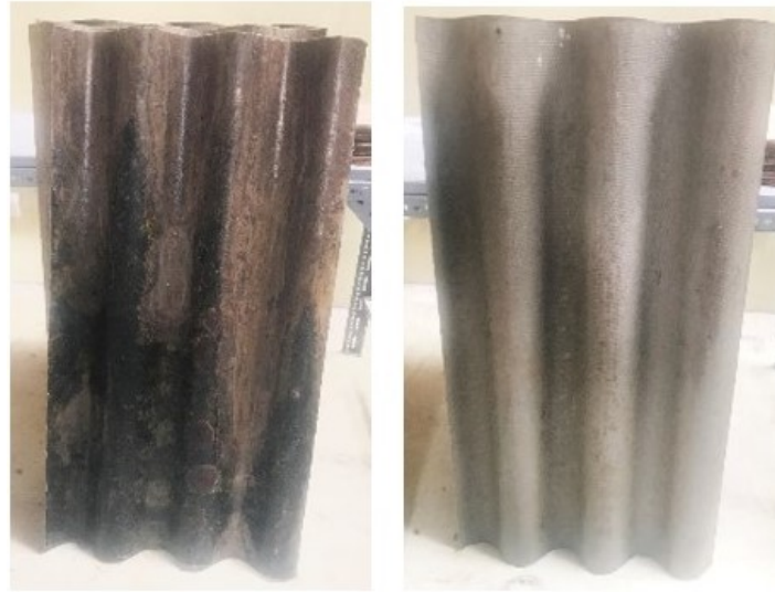
c). Pieza Fibrocemento expuesta a ceniza volcánica, luego de haber sido sumergida en agua. d). Pieza Fibrocemento nueva, luego de haber sido sumergida en agua.
