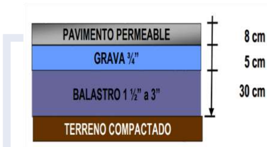
Imagen 29. Sección para colocación de Pavimento Permeable
