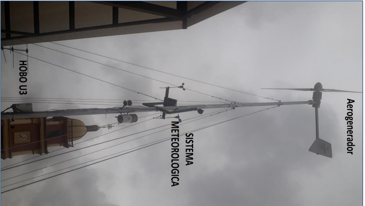
Ilustración 7. Sistema Meteorológico de Medición de Clima para la Recopilación de Datos de Radiación Solar y Fotovoltaico
