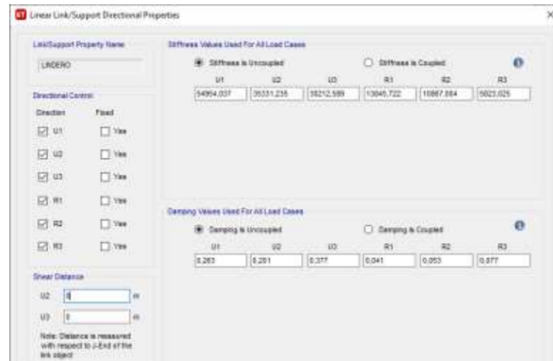
Ilustración 88. Rigidez dinámica y Factor de amortiguamiento para zapatas de lindero. Fuente: Autor
