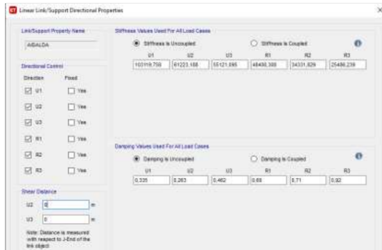
Ilustración 87. Rigidez dinámica y Factor de amortiguamiento para zapatas aisladas. Fuente: Autor
