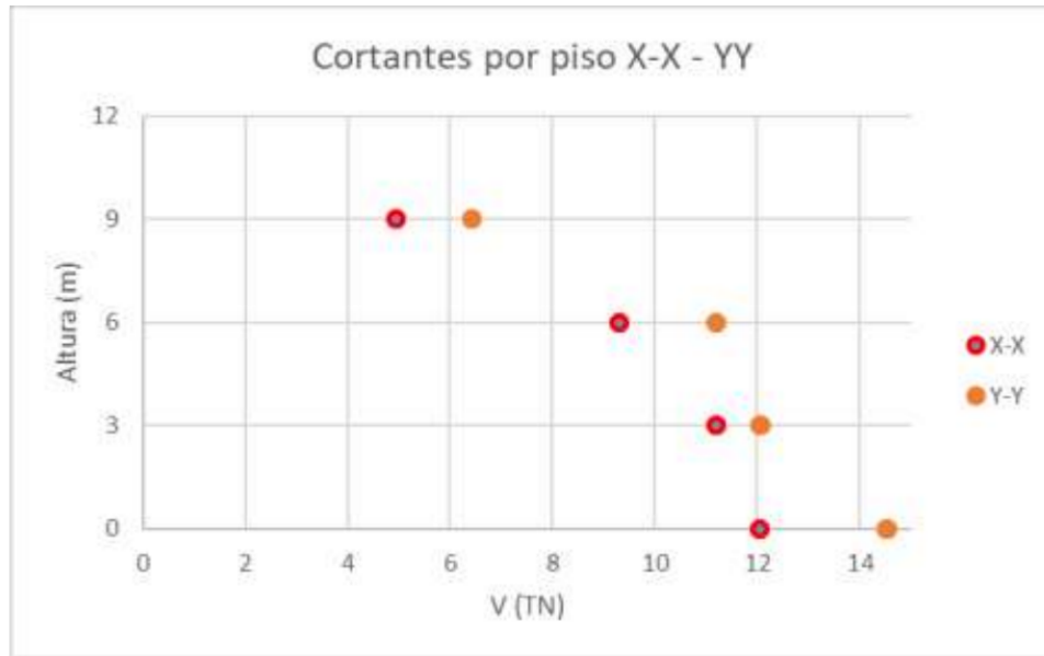
Ilustración 96. Cortantes por piso. Fuente: Autor
