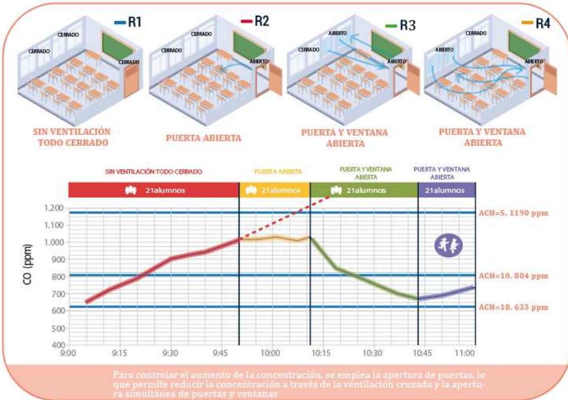
Figura 14: Variación de concentración de co2 en diferentes condiciones de ventilación.
