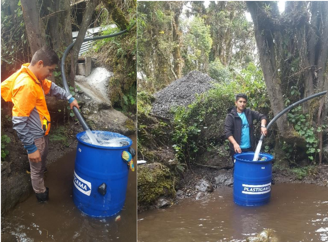
Fig. 31 Medición del caudal en la tubería de presión.
