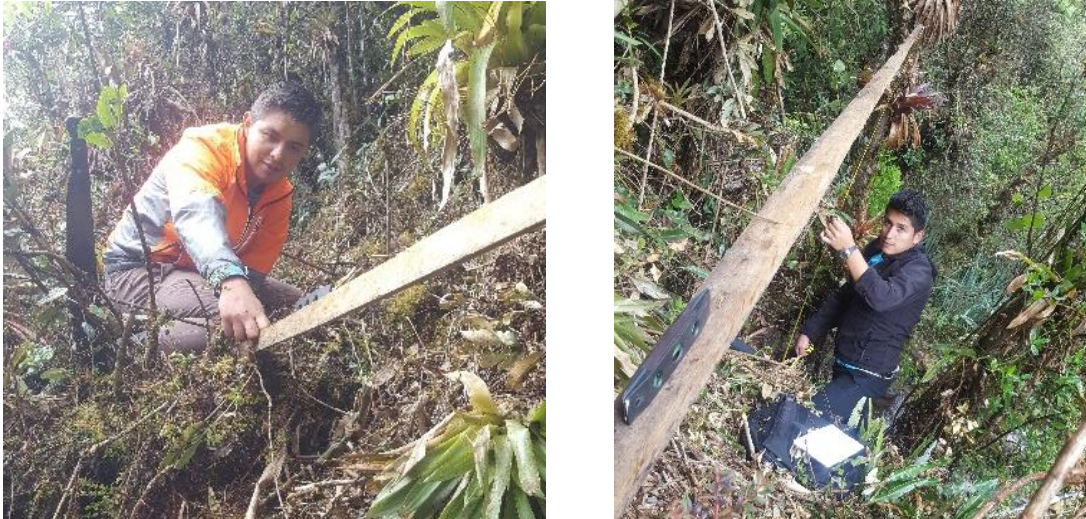
Fig. 38 Medición de altura Bruta con el método de nivel de Carpintero (Autores, 2018)
