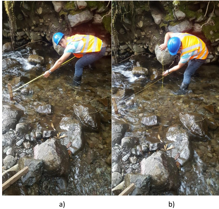
Fig. 24 Medición transversal y profundidades. (Autores, 2018)
