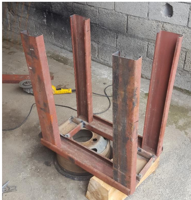
Fig. 48 base de la turbina en construcción.
