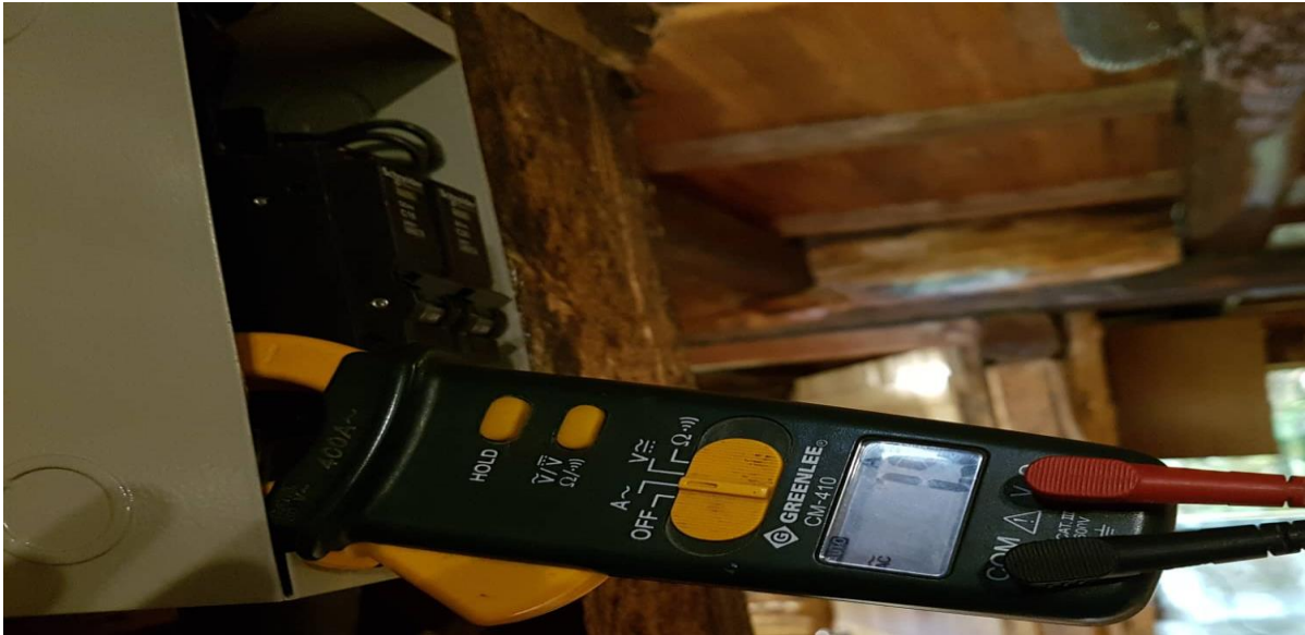
Fig. 64 Amperaje de salida con todas las cargas activas (Autores, 2018)
