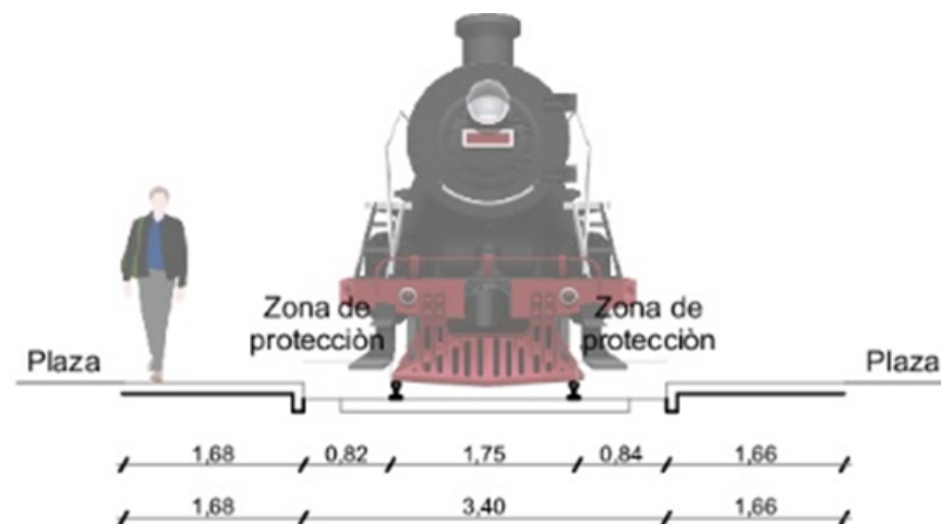
FIGURA 2.11: Vía férrea Elaboración: Autora, 2020
