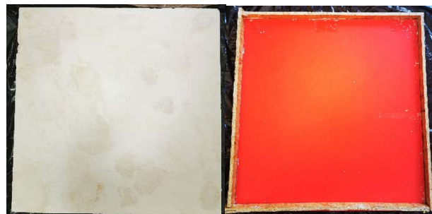
(1) Panel prefabricado, (2) Molde de panel.
