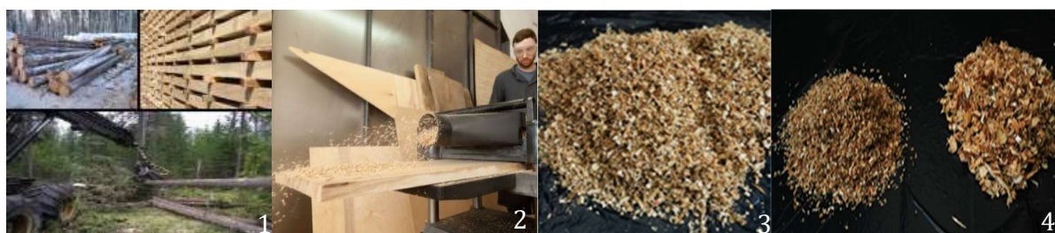
FIGURA 2.3: Tratamiento de la fibra de pino hasta conseguir viruta.
