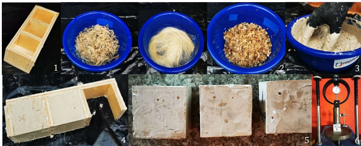
FIGURA 2.7: Proceso de ensayo de compresión.
