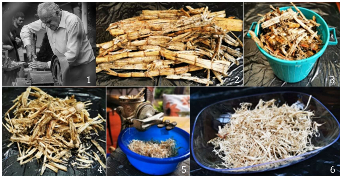
FIGURA 2.2: Tratamiento de la fibra de bagazo
