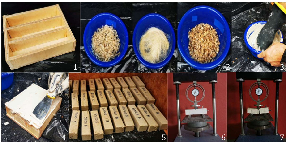
FIGURA 2.6: Proceso de ensayo de flexión
