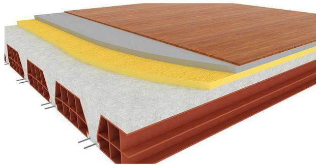
Figura 36. Piso con aislamiento de Poliuretano Proyectado.
