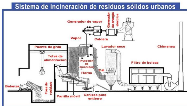
Figura 62. Sistema de Incineración.
