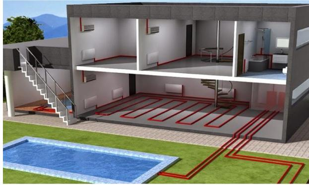
Figura 57. Sistema de bomba de calor geotérmica.
