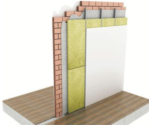
Figura 34. Muro con aislamiento de Poliestireno Expandido (EPS).
