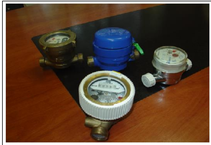
Ilustración 2. Medidores Chorro Único Fuente: DAIAS. Etapa EP
