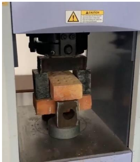
Figura 48: Resultados a compresión de las cruces y trios y perforados. Fuente: (Propia)
