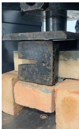
Figura 38: Ensayo de los especímenes tipo cruz. Fuente: (Propia)
