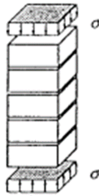
Figura 3: Arreglo propuesto para compresión uniaxial. Fuente: (Alcocer, 1996)
