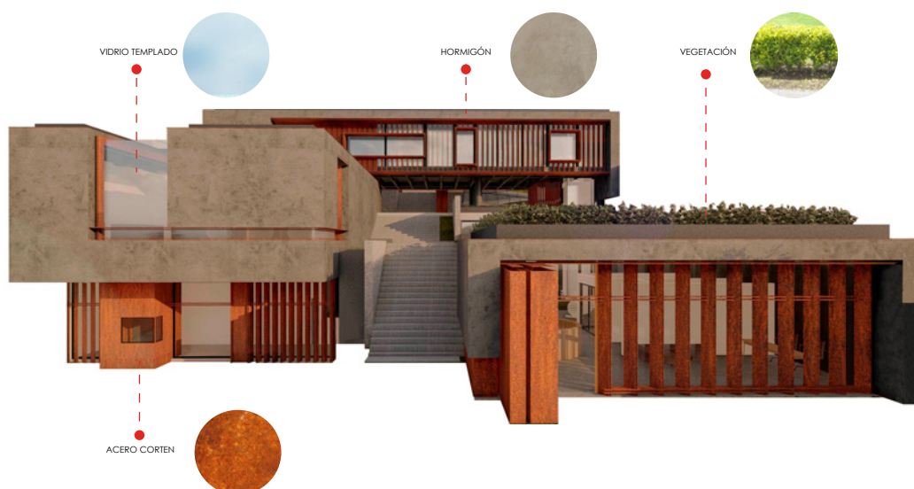
FIGURA 3.17: Materiales aplicados en el exterior. Fuente: Elaboración propia.
