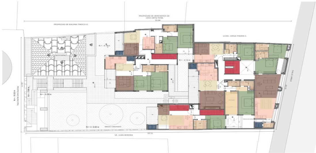
BLOQUE C, PLANTA DE CUBIERTAS - BLOQUE B, TERCERA PLANTA N+5.75 - BLOQUE A, 3RA PLANTA N+7.08. ESC: 1:350
