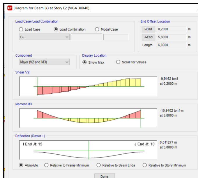
Figura 24 Diagramas de momentos y deflexiones en la viga más desfavorable. Fuente: Elaboración Propia.
