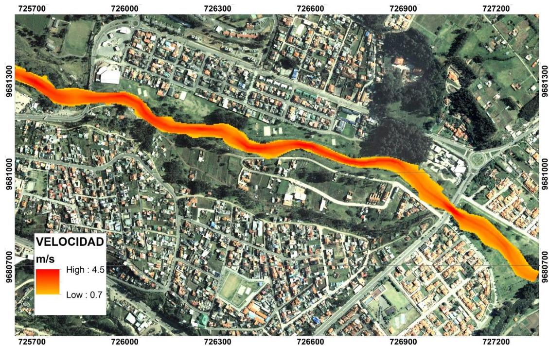
Ilustración 64: Mapa de amenaza de inundación Río Machángara DJ Río Chulco hasta AJ Río Cuenca (TR 100 años) Velocidad.
