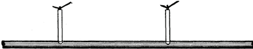
Tubería móvil sobre la superficie (fácil de transportar).
