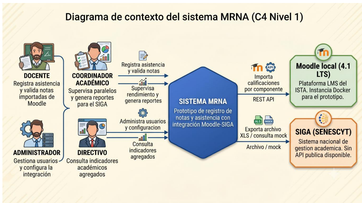
Figura 3. Diagrama de contexto del sistema MRNA (C4 nivel 1). Nota. Elaboración propia con asistencia de inteligencia artificial, 2026.
