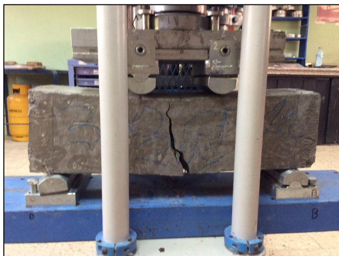
Ilustración 21 Rotura de vigas de hormigón sin fibra con cemento Holcim Tipo GU
