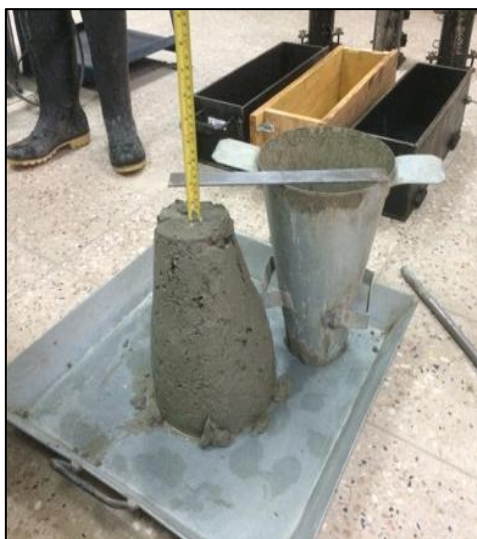
Ilustración 12 Medición del asentamiento por el método de “Cono de Abrams”
