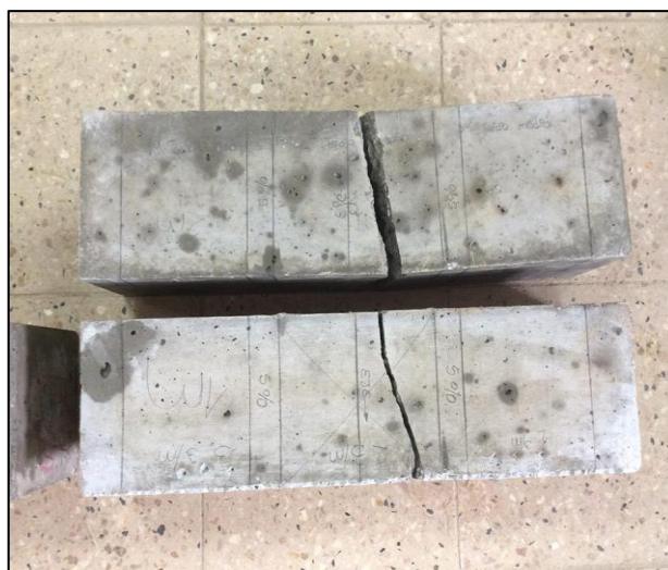
Ilustración 20 Fallas ubicadas dentro del tercio medio de la longitud entre apoyos en vigas de hormigón
