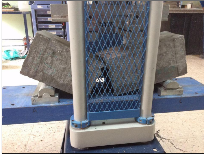
Ilustración 24 Rotura de vigas de hormigón sin fibra con cemento Guapan Tipo IP
