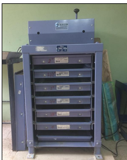
Ilustración 3 Máquina tamizadora para el agregado grueso.
