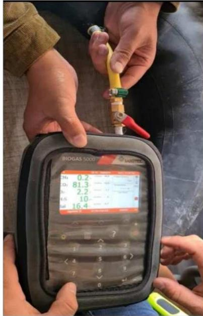
**Figura 31: Resultado de la composición de la muestra del tubo grande.**
