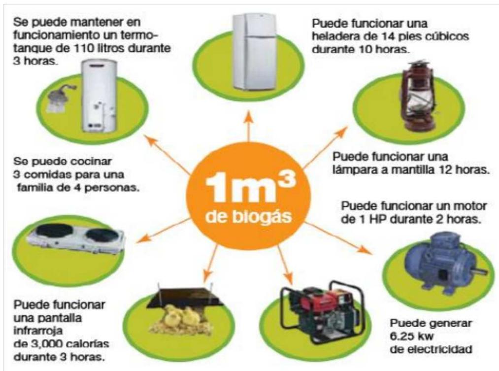
**Figura 10: Uso del biogás para 1 m<sup>3</sup>.**
