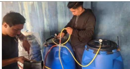
Asegurar la hermeticidad en las mangueras mediante abrazaderas al inicio y final de cada manguera industrial.
