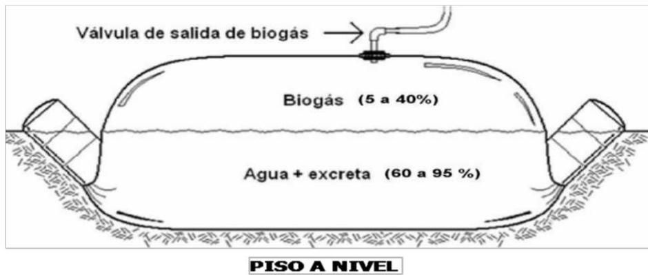
**Figura 5: Biodigestor de plástico de bajo costo.**
