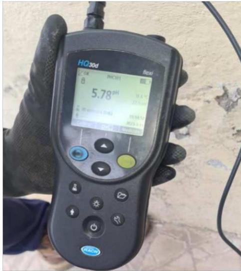
*Figura 34: Obtencion del Ph del reactor 1.
