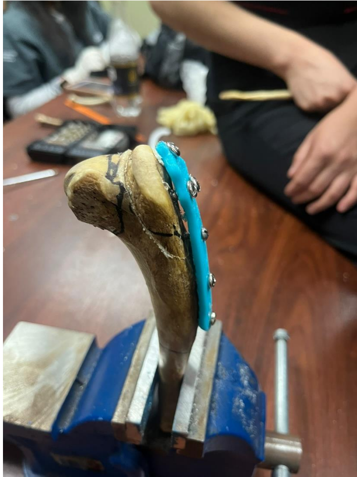
Anexo 16: Vista final de la fijación de la placa en un hueso y fractura real
