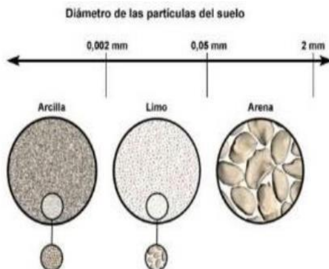
Figura 2: Representación de los tamaños de partículas que conforman el suelo.
