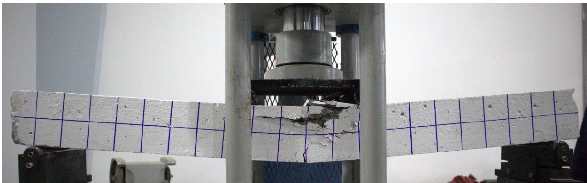
Figura 39 Deterioro bajo carga de compresión observado en la prueba del modelo físico
