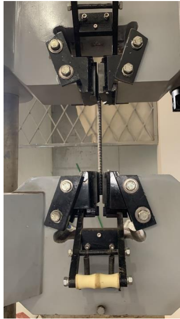
Figura 21 Disposición utilizada en la prueba de barras acero.
