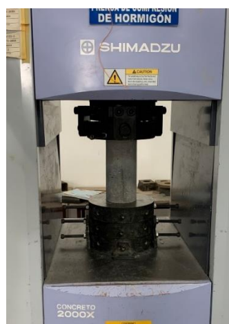
Figura 24 Disposición para la prueba de compresión de los cilindros.
