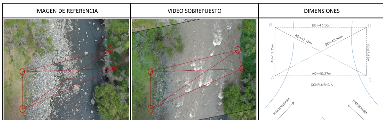
Ilustración 25 Corrección de distorsión y escala del video. Fuente: Propia.
