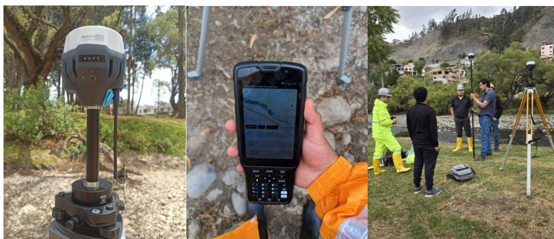
Ilustración 3. Equipo topográfico Base, Colector y Rober. Fuente: Propia.
