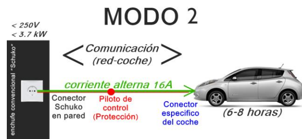
Fig. 22. Modo 2 de carga.
