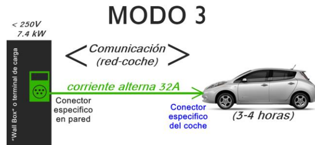
Fig. 23. Modo 3 de carga.
