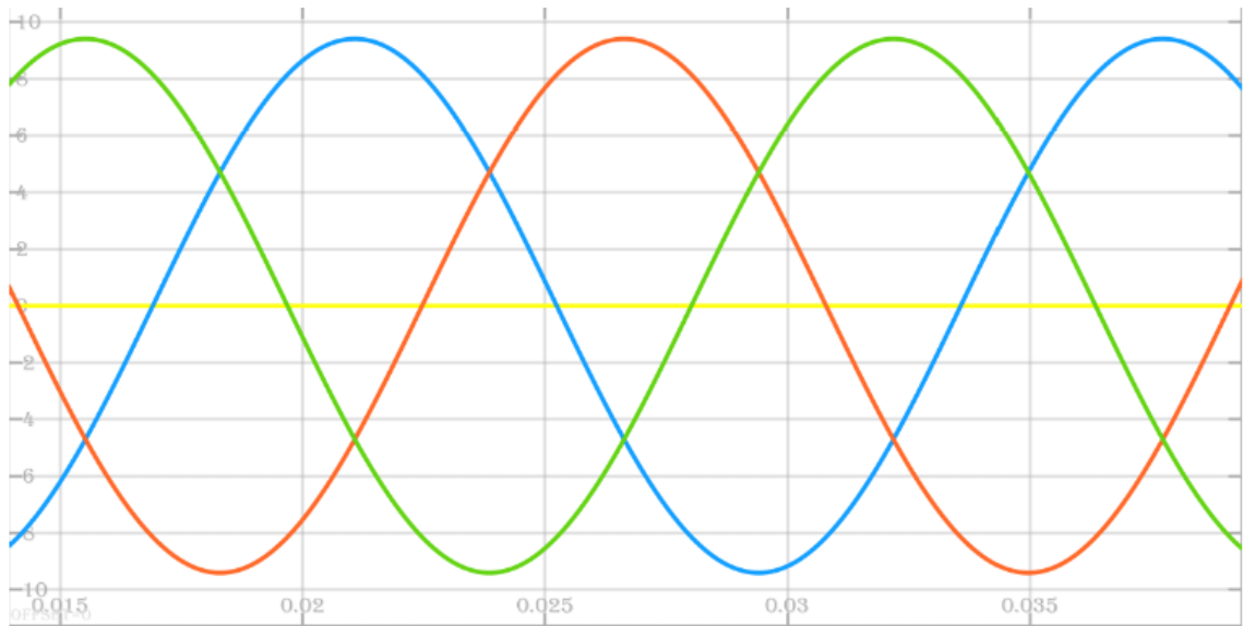
Fig. 55. Ondas de corriente de media tensión trifásica sin haber conectado la estación de carga rápida.
