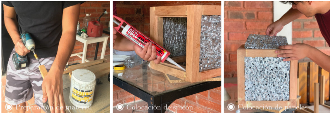
Figura 3.10: Procesos de elaboración de módulo experimental
