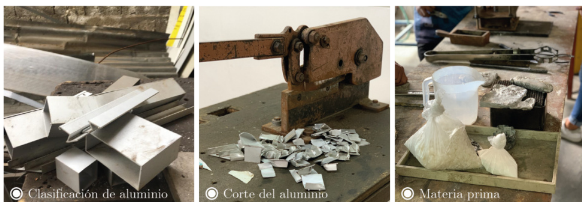
Figura 2.18: Preparación de aluminio y elementos
