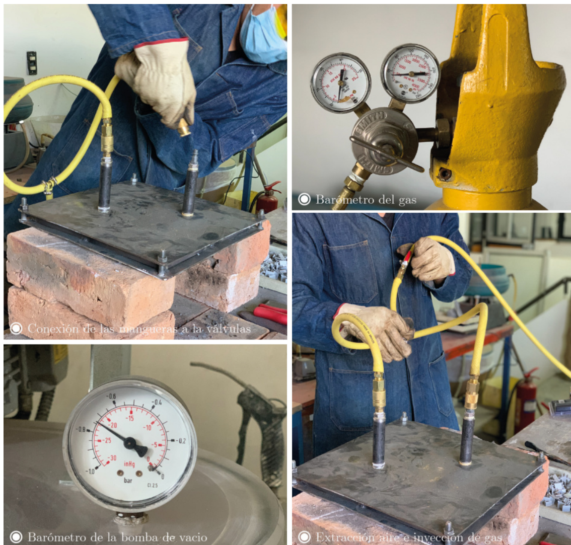
Figura 2.24: Procesos de extracción e inyección de gas
