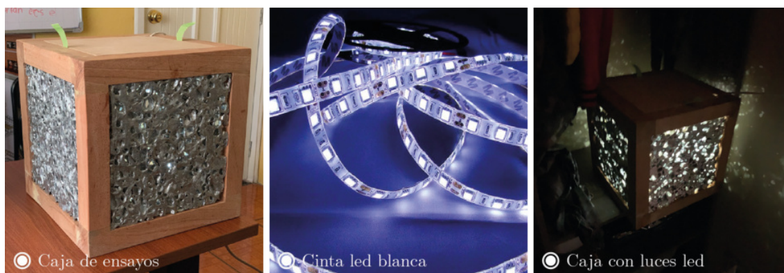
Figura 3.24: Prueba de transmitancia lumínica artificial interior
