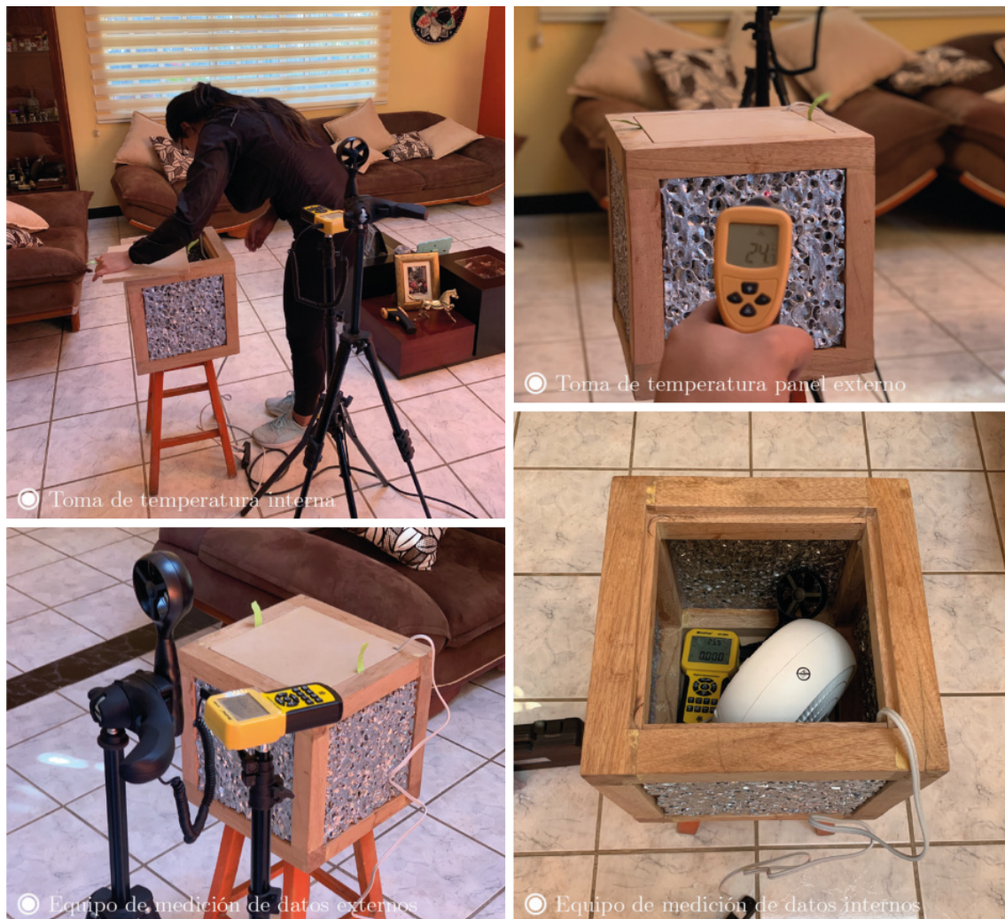
Figura 3.16: Proceso de toma de datos para cálculo de la conductividad térmica del panel
