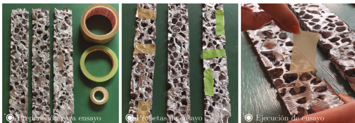
Figura 3.28: Procesos de elaboración de módulo experimental
