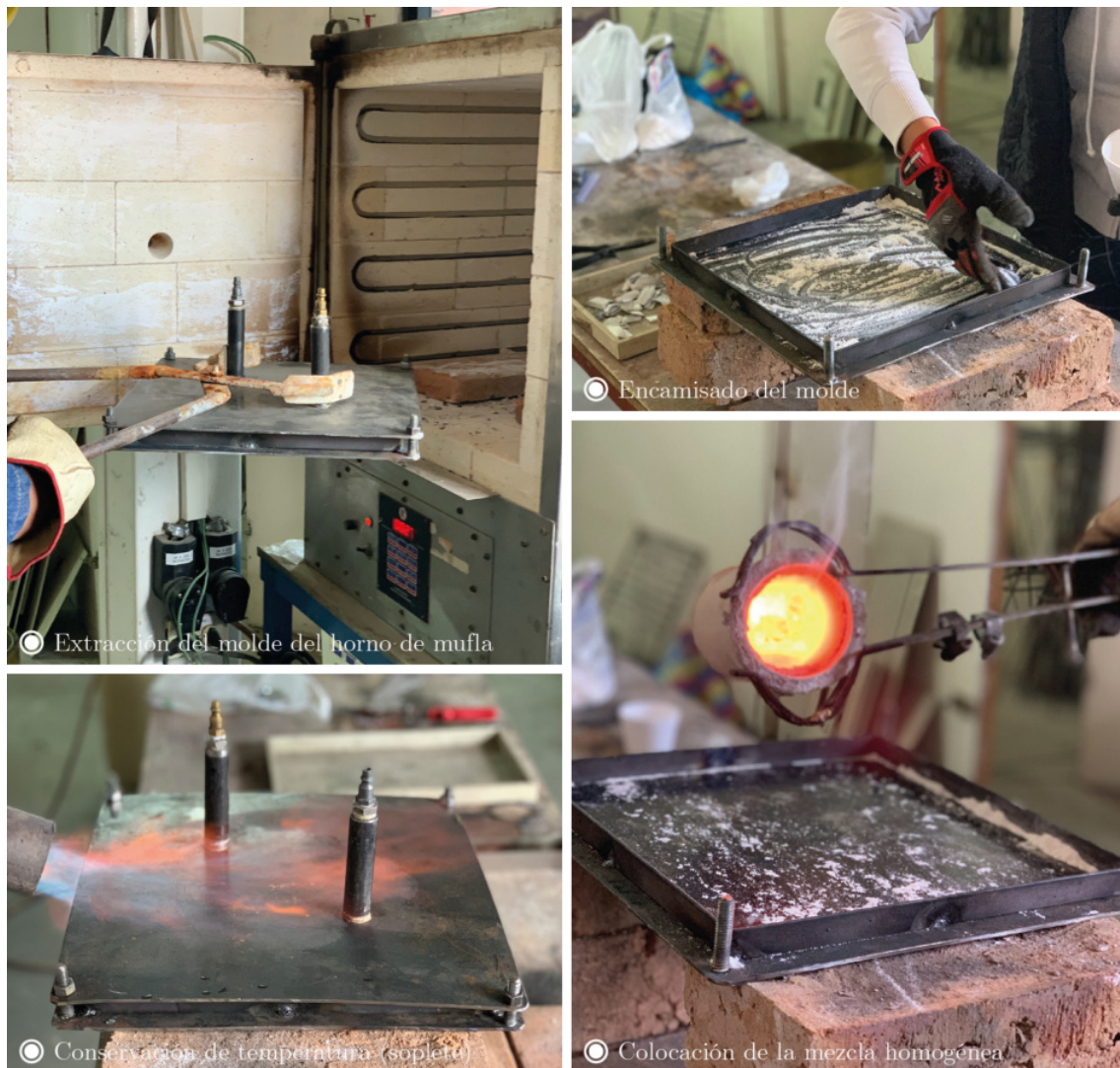
Figura 2.23: Procesos de colocación de la colada
