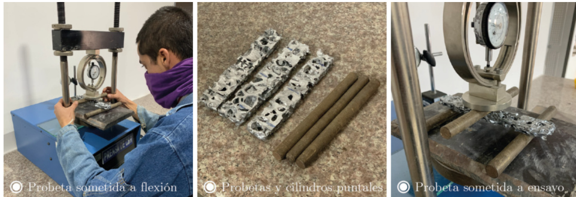
Figura 3.5: Probetas y equipo en la prueba de flexión
