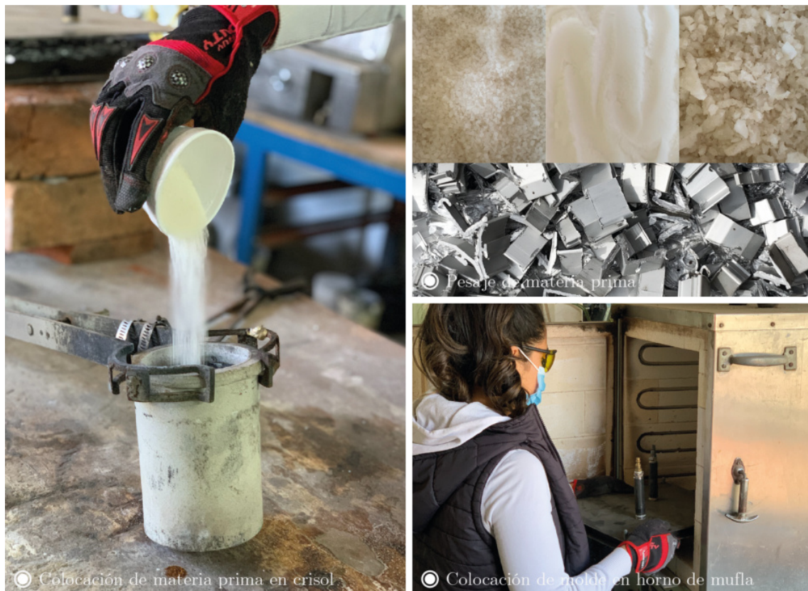
Figura 2.21: Colocación y fundición de materia prima
