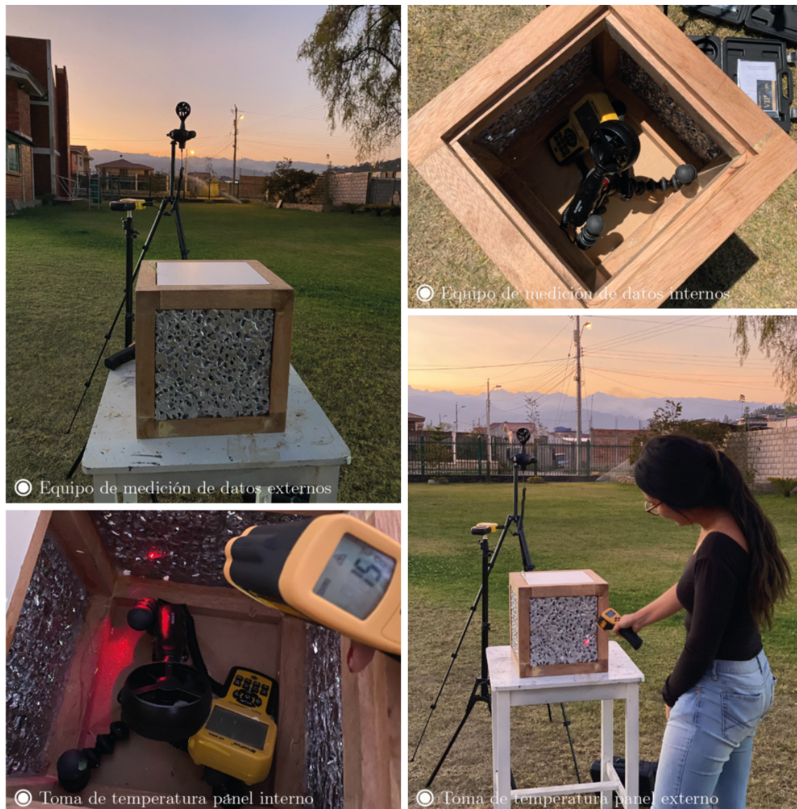
Figura 3.13: Proceso de toma de datos para cálculo del comportamiento del panel
