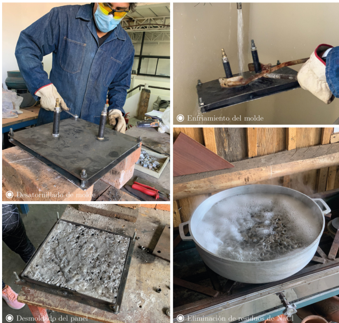
Figura 2.25: Desmoldado y lavado del panel
