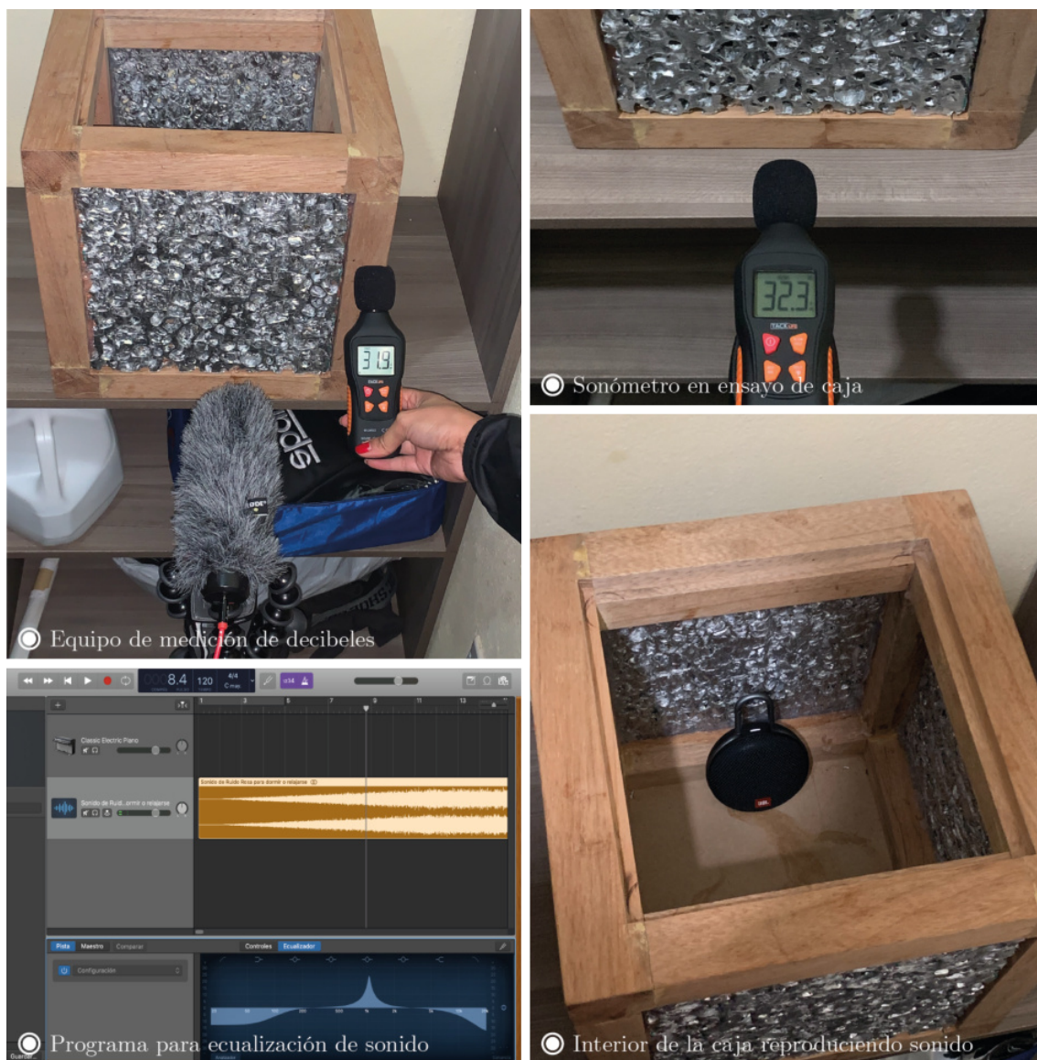
Figura 3.19: Proceso de toma de datos para el cálculo de aislamiento acústico
