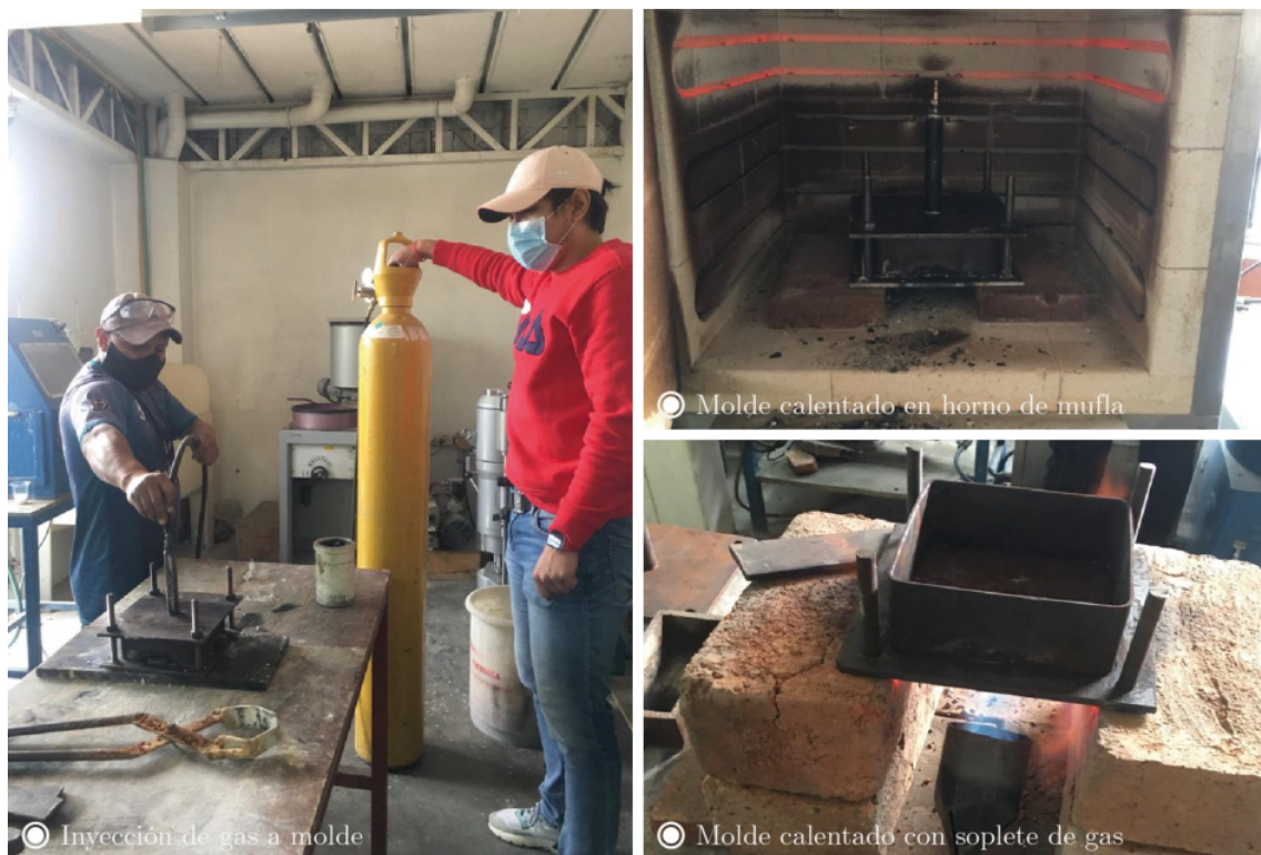
Figura 2.9: Procesos de elaboración de probetas
