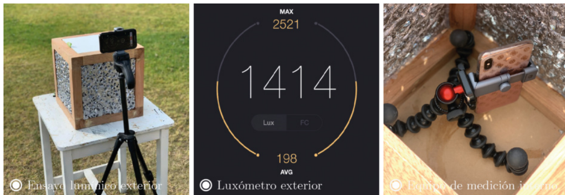
Figura 3.22: Prueba de transmitancia lumínica natural
