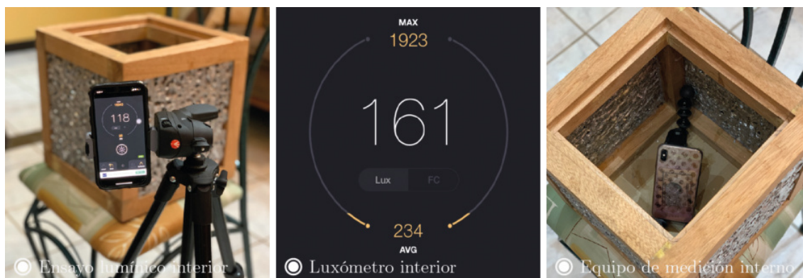
Figura 3.23: Prueba de transmitancia lumínica artificial exterior
